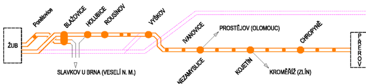
Obrázek 29 Navržené kolejové schéma trati – varianta O2+
