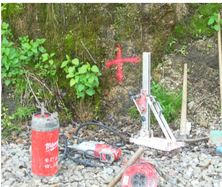
Vrtání ruční vrtačkou Milwaukee - Jablonec n. N.
