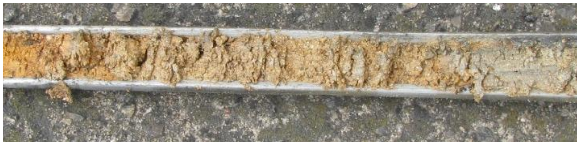
sonda ZS 3 (detail výnosu): charakter zemin podloží násypu drážního tělesa (mimo těleso komunikace I/20)
