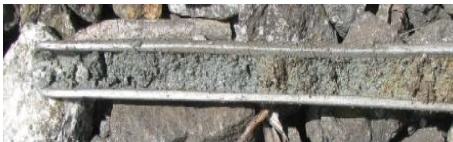
sonda ZS 1 (detail výnosu): charakter zemin podloží násypu drážního tělesa (severní část), voda v úrovni -1,2m pod úložnou plochou pražce (šedomodrá barva a zápach svědčí o vysokém obsahu organických látek)
