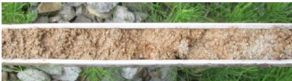
sonda ZS (detail výnosu): charakter zemin podloží násypu drážního tělesa (jižní část), podzemní voda nezastížena
