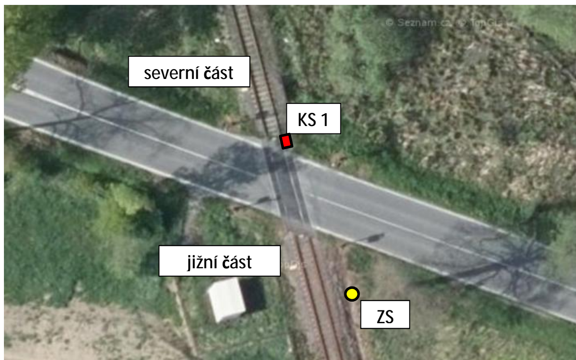
Železniční přejezd P1348 v km 23.017: situace kombinované sondy (KS 1) a strojně zarážené sondy (ZS)
