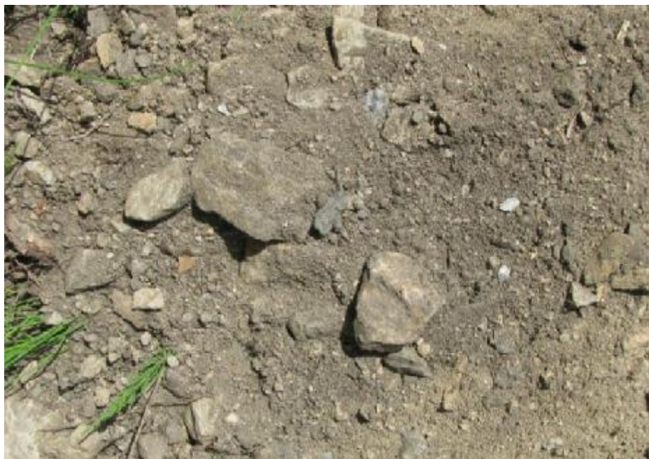
sonda KS 1: charakter zemin násypu drážního tělesa (mimo konstrukční a podkladní vrstvy pozemní komunikace I/20)
