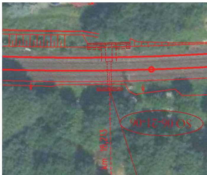
Obr. 13 SO 06-21-06 Mstětice - Praha Horní Počernice, propustek v ev. km 18,780, dotčené území Horní Počernice, stávající stav: vlevo kamenná klenba sv. 2,0 m, vpravo deska ze zabetonovaných kolejnic sv. 2,0 m
