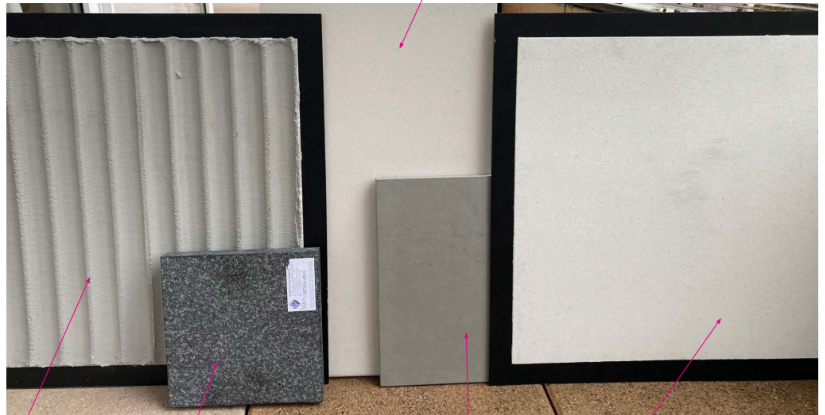
MAT 01 lamely ohýbaný profil s hrubým nástřikem (matný vzhled) barva bílo-šedo-běžová přibližný RAL1013
