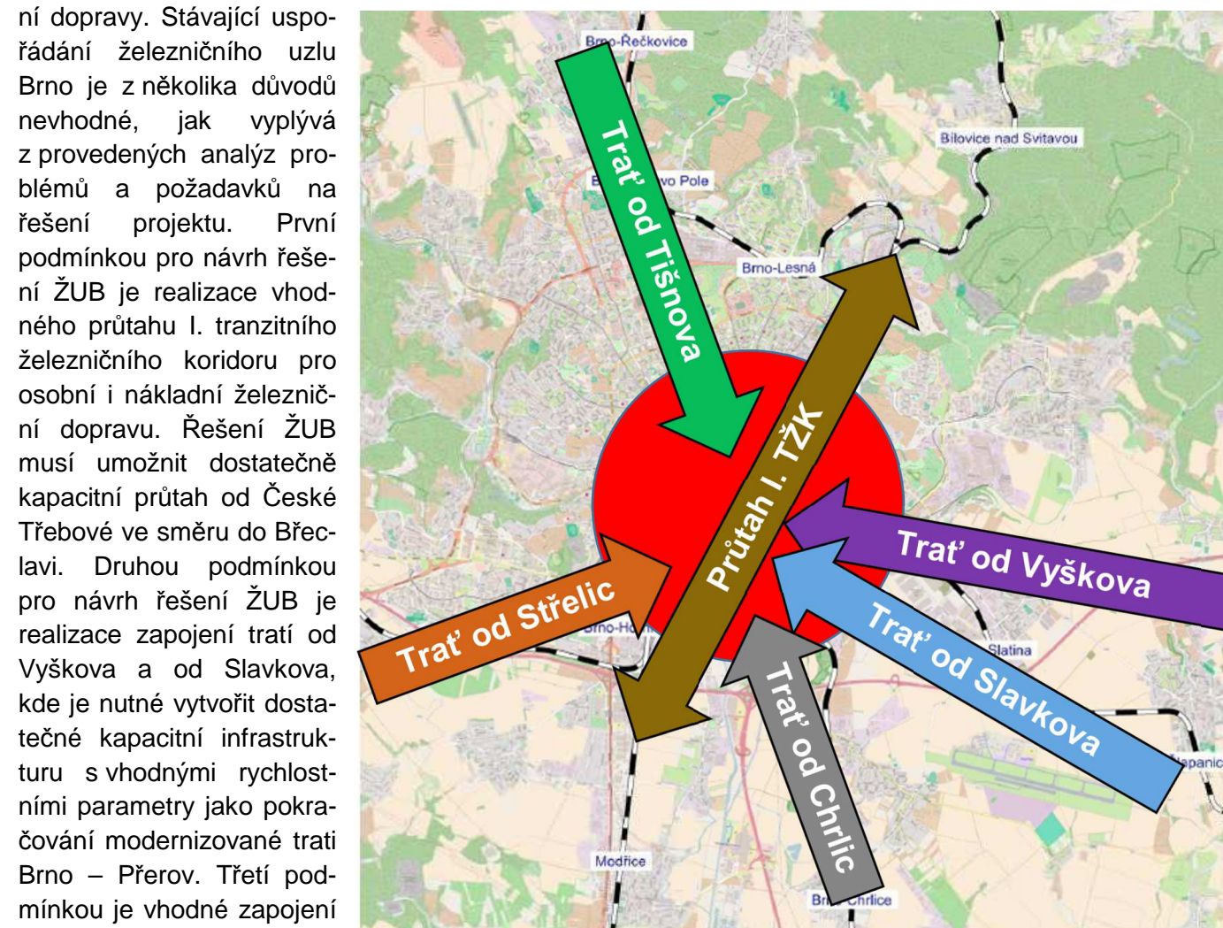
Obrázek 53 - Základní možnosti zapojení tratí do ŽUB
