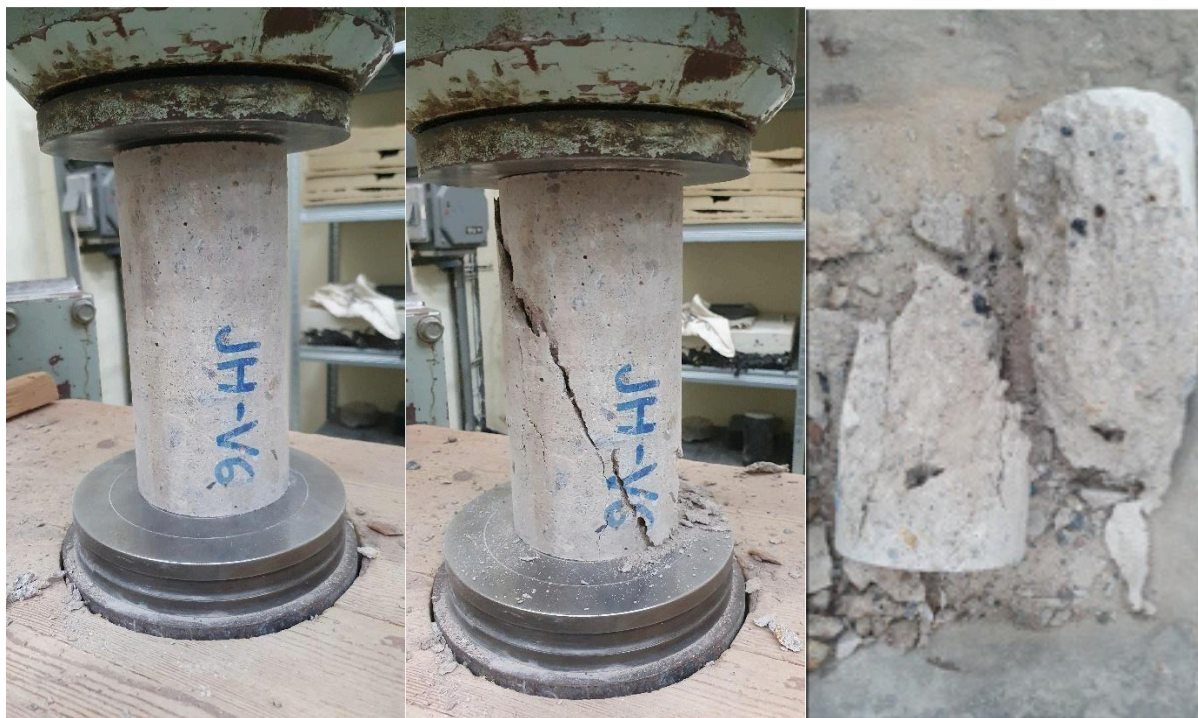
Obrázek 119 – Vzorek V6 před zkouškou a po zkoušce
