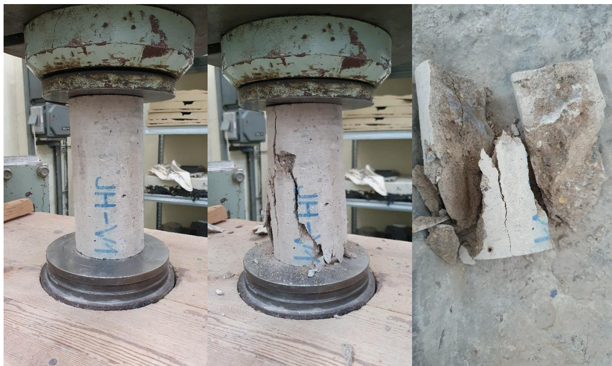
Obr. 3: Vzorek V1 před zkouškou a po zkoušce v tlaku
