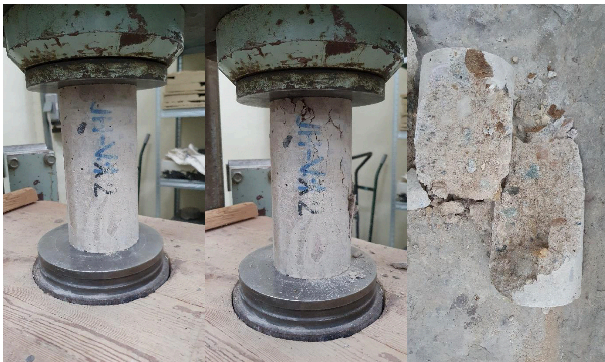
Obrázek 115 – Vzorek V2 před zkouškou a po zkoušce v tlaku
