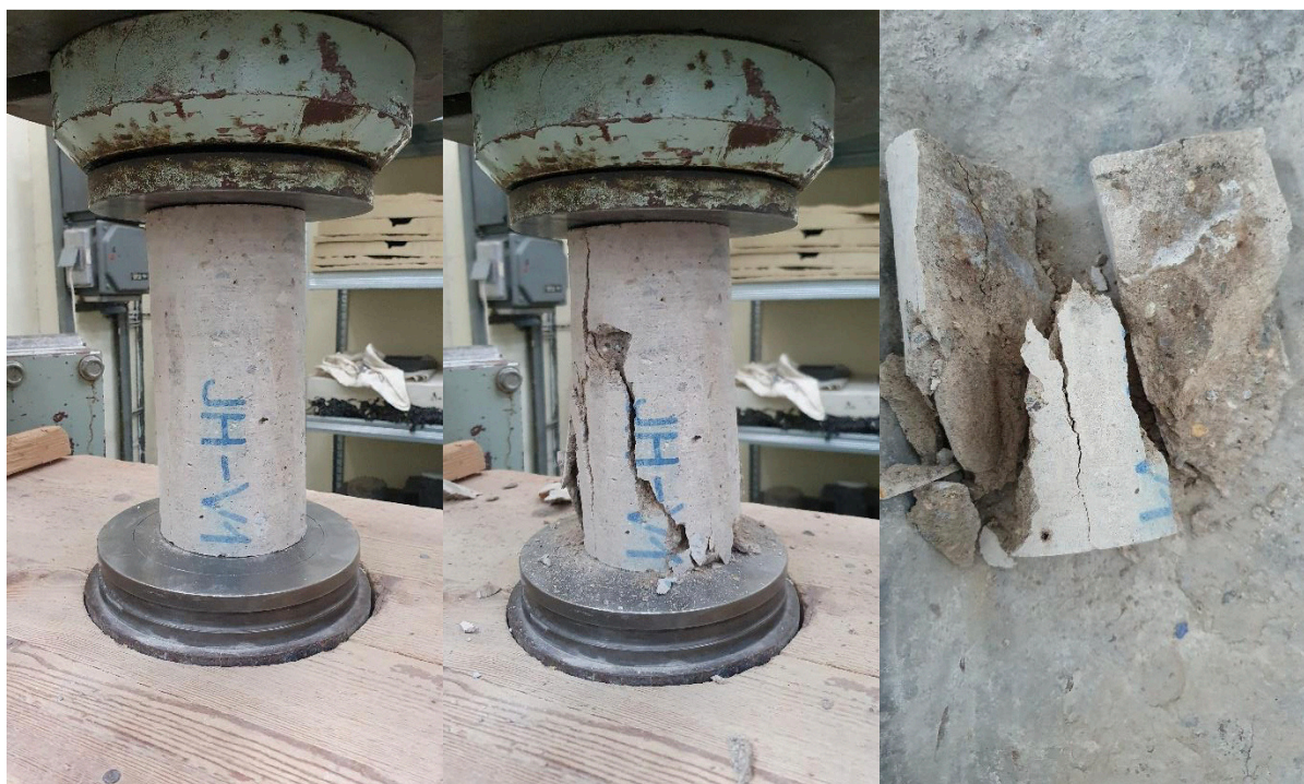
Obrázek 114 – Vzorek V1 před zkouškou a po zkoušce v tlaku
