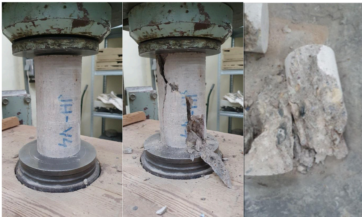
Obrázek 117 – Vzorek V4 před zkouškou a po zkoušce v tlaku
