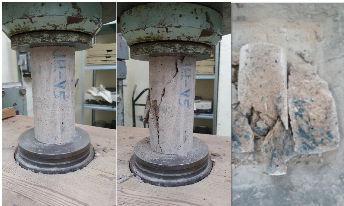
Obrázek 118 – Vzorek V5 před zkouškou a po zkoušce
