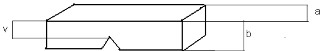
Obrázek 43 - Velikost zkušebního tělesa
