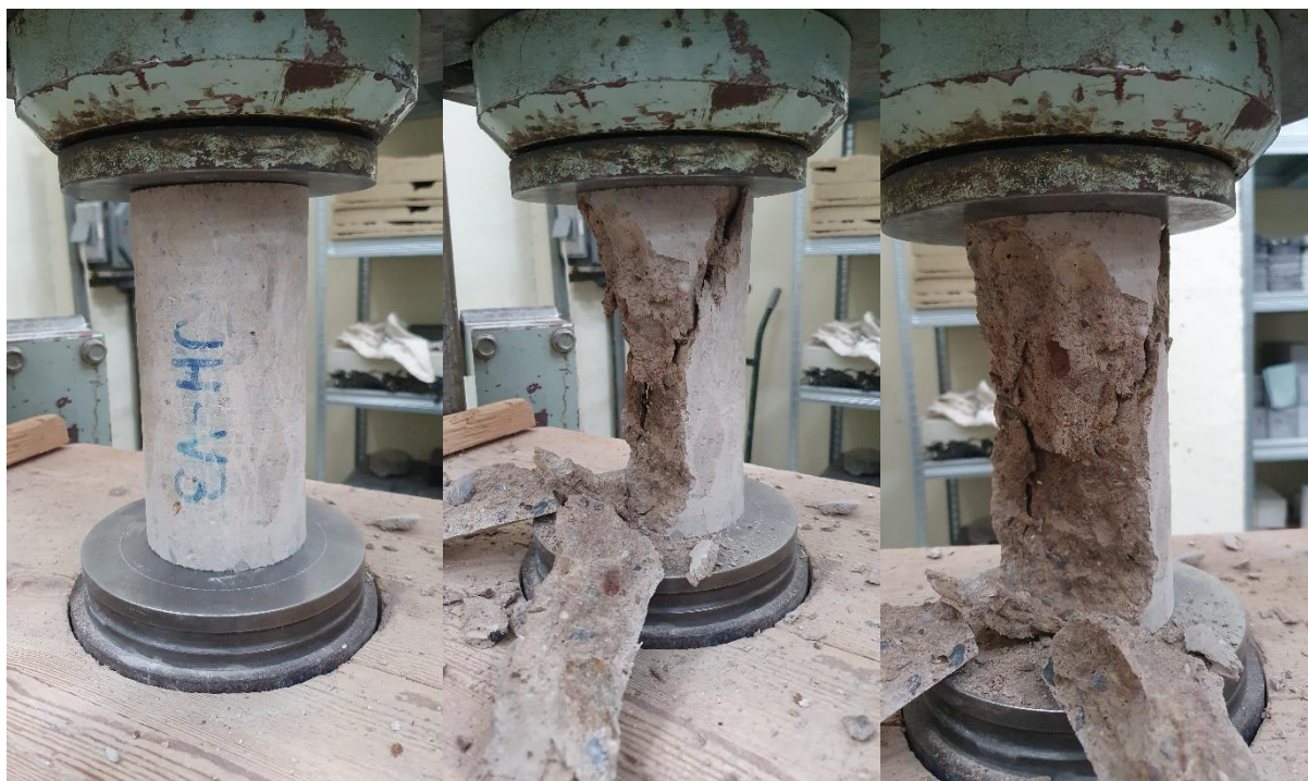
Obr. 5: Vzorek V3 před zkouškou a po zkoušce v tlaku
