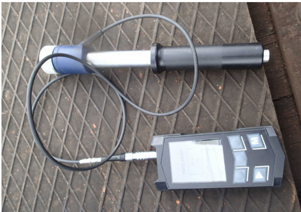
Obrázek 29 - Tvrdoměr typu KT-C se sondou typu G
