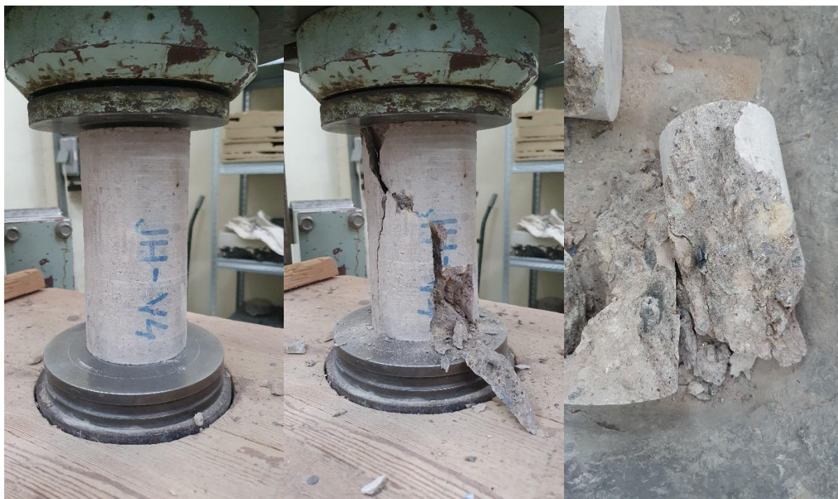
Obr. 6: Vzorek V4 před zkouškou a po zkoušce v tlaku
