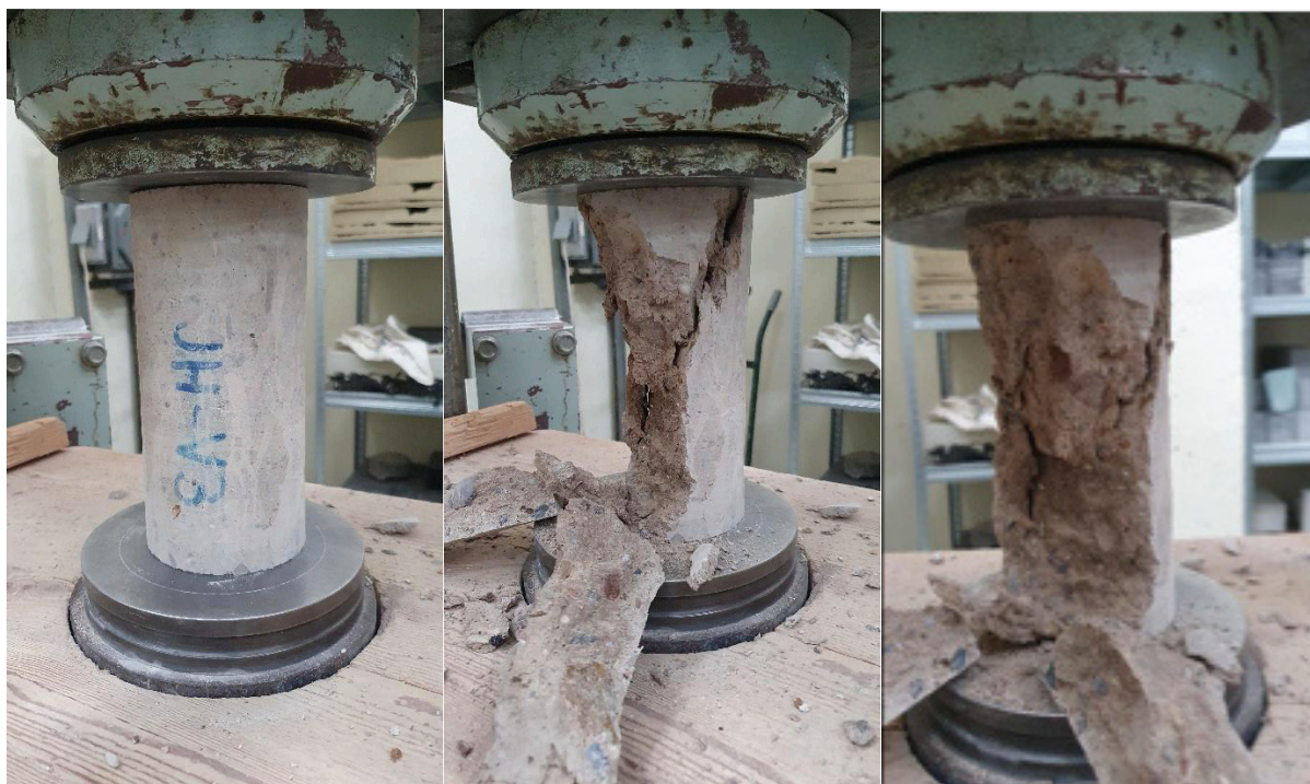
Obrázek 116 – Vzorek V3 před zkouškou a po zkoušce v tlaku
