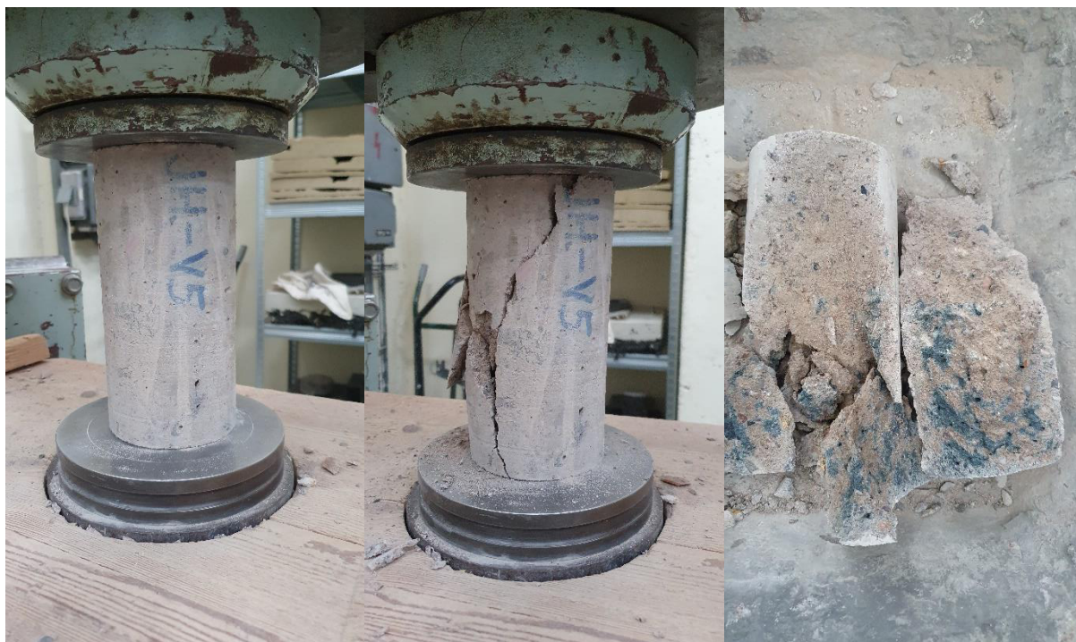
Obr. 7: Vzorek V5 před zkouškou a po zkoušce v tlaku
