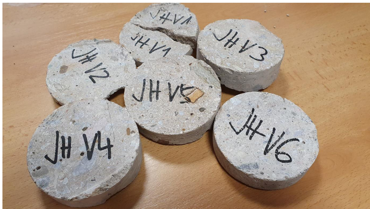
Obr. 2: Vzorky po zkoušce mrazuvzdornosti
