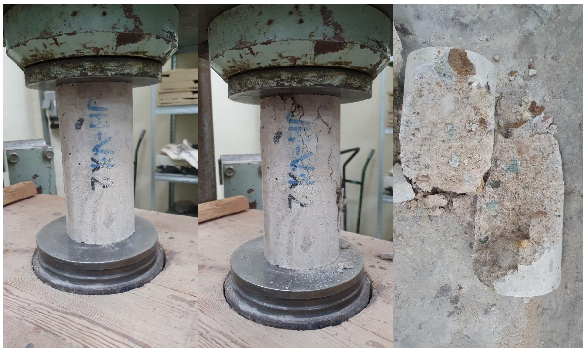
Obr. 4: Vzorek V2 před zkouškou a po zkoušce v tlaku
