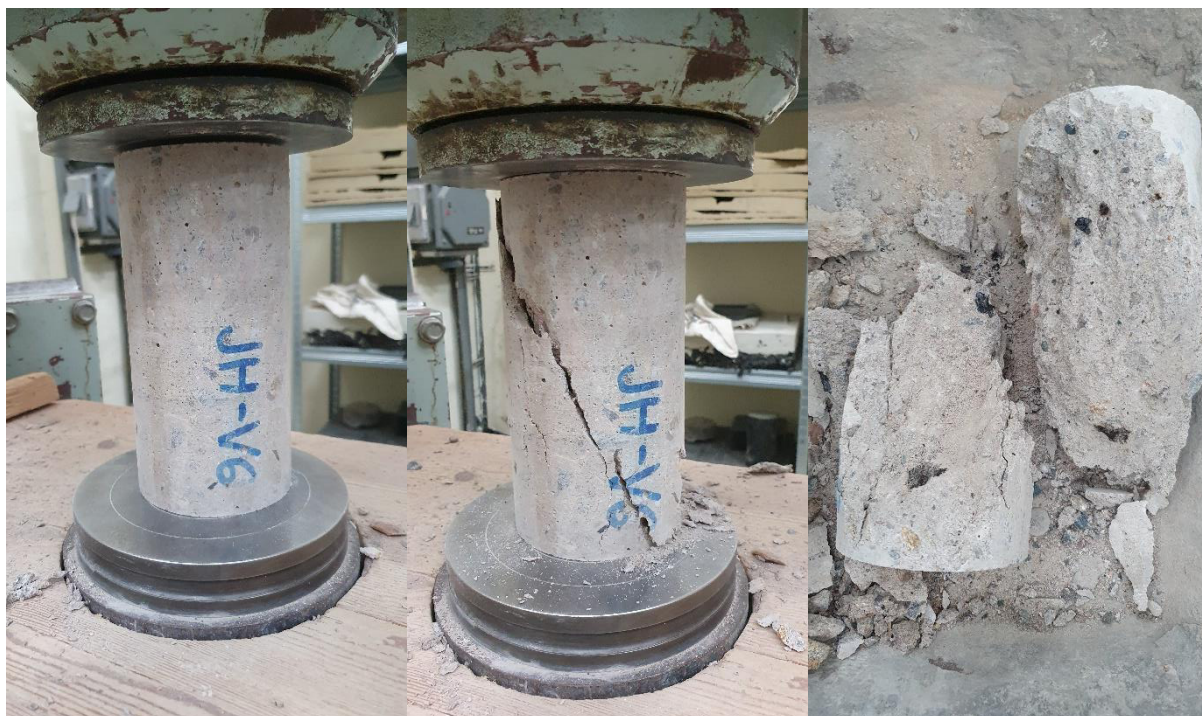
Obr. 8: Vzorek V6 před zkouškou a po zkoušce v tlaku
