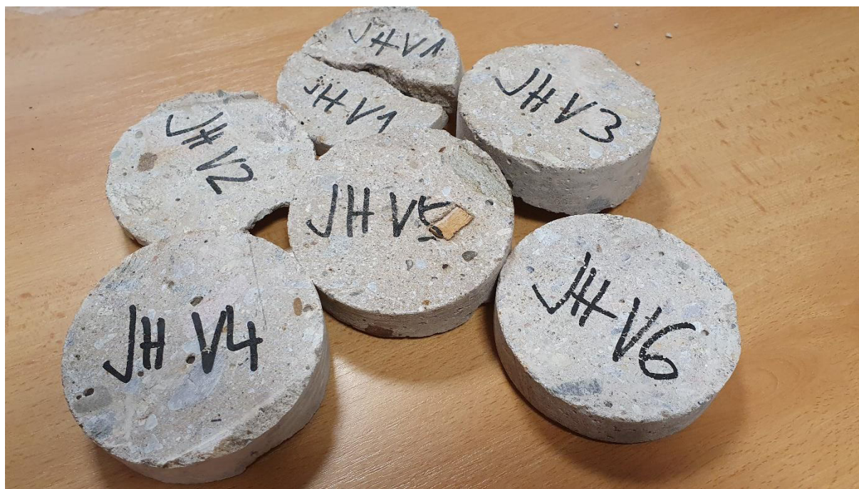
Obrázek 124 – Vzorky po zkoušce mrazuvzdornosti
