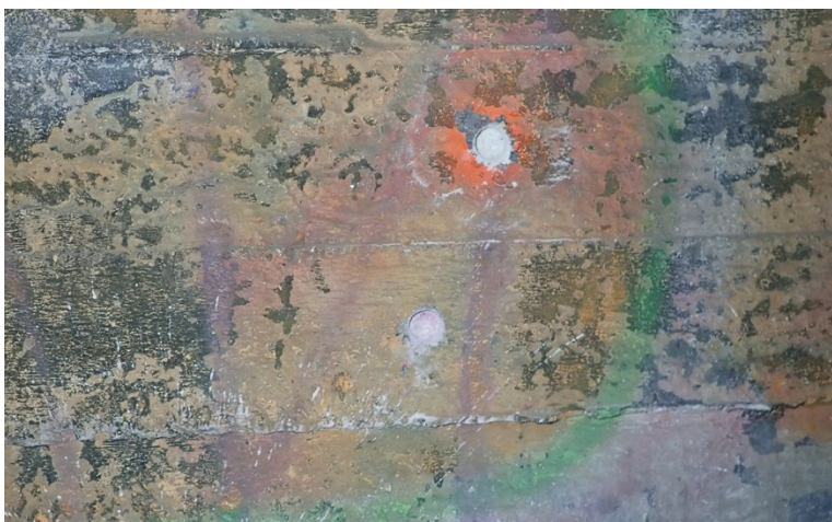
Obrázek 122 - Ukázka měření karbonatace přímo na konstrukci
