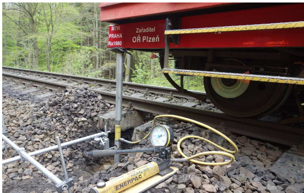
Foto 2: Statická zatěžovací zkouška v sondě K1 v km 174,400
