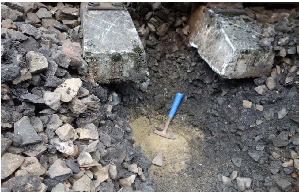
Foto 2: Statická zatěžovací zkouška v sondě K1 v km 174,400
