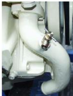
obr. 5: Hlavní vypouštěcí kohouty pro vypouštění chladicí kapaliny
