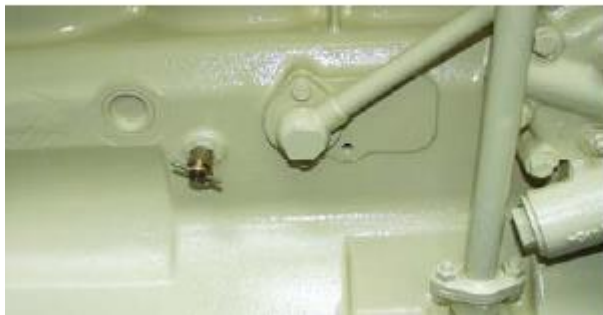
obr. 5: Hlavní vypouštěcí kohouty pro vypouštění chladicí kapaliny
