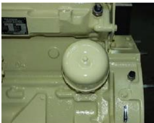
obr. 4: Odstředivý čistič
