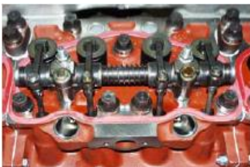
obr. 6: Pohled na ventilové pružiny a vahadla
