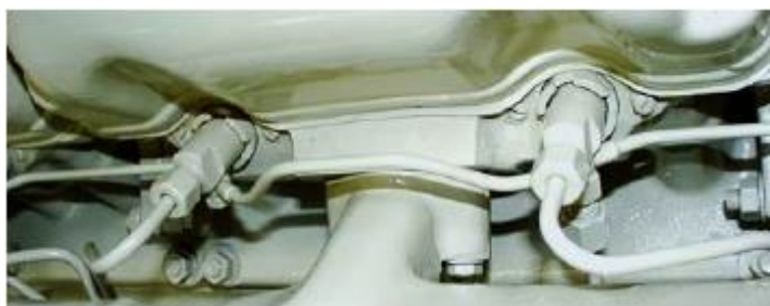
obr. 10: Pohled na vstřikovače
