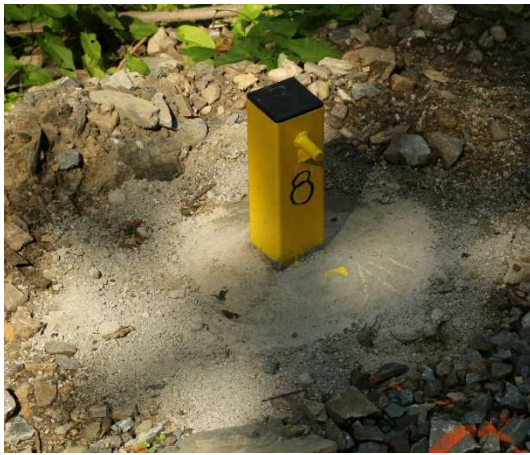
Obrázek 21 Značka typu Tomi-Remont
