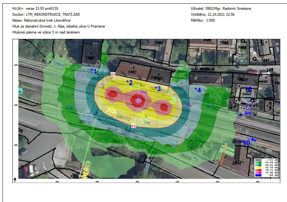
Obr. č. 4 Hluk ze stavební činnosti, fáze 1, hluková pásma ve výšce 3 m nad terénem
