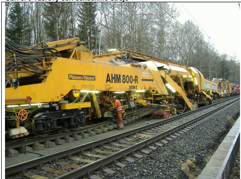
Obr. č. 5 Vzorový obr. sanačního stroje
