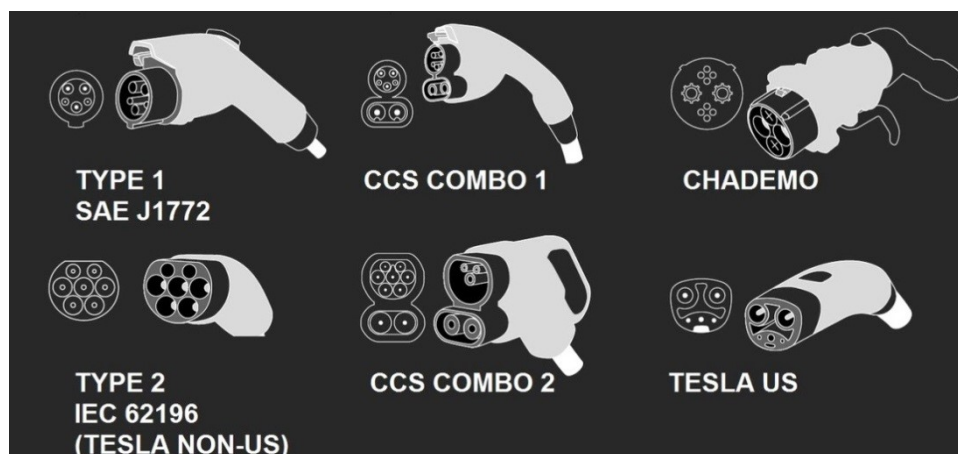
Obrázek č. 3 - Běžné typy konektorů pro nabíjení
