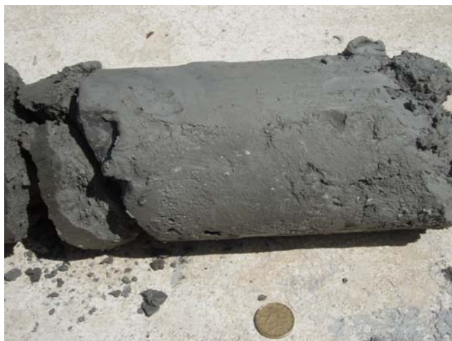
Obr. Jádro z dvojité jádrovnice po vyjmutí
