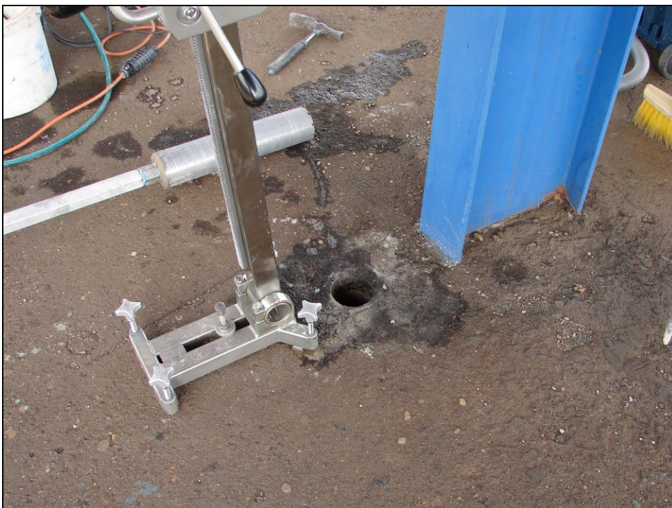
Foto 5: 3. nástupiště, základ sloupu 2, jádrový vývrt 4; pozice vývrtu proti stojině sloupu, v hl. 880 mm pod horním lícem základu zachycena azbestocementová roura vyplněná cementovou maltou
