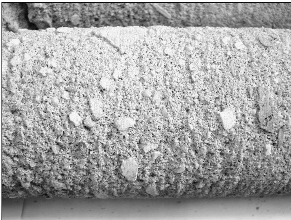
Foto 12: 3. nástupiště, základ sloupu 2; silně pórovitá struktura betonu základu sloupu (pro zvýraznění černobílé foto)
