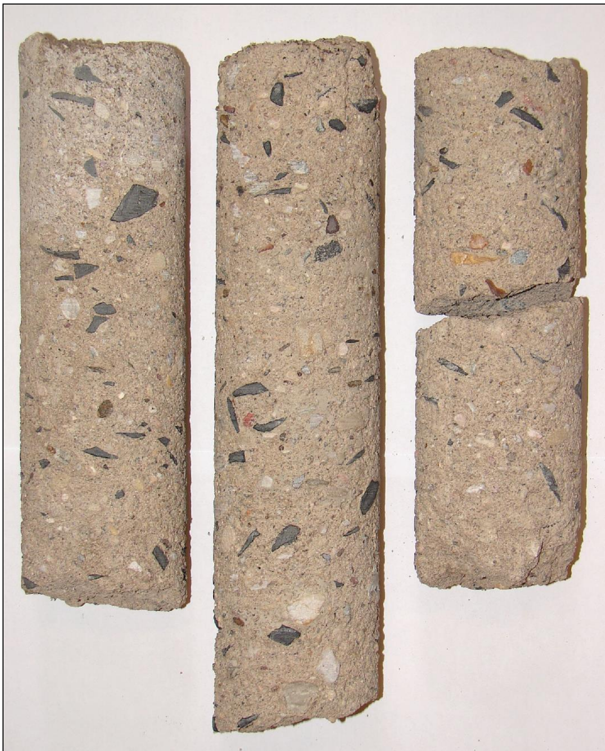
Foto 9: 3. nástupiště, základ sloupu 13; jádrový vývrt ze základu sloupu, beton vykazuje známky nízkého obsahu cementu
