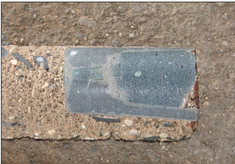
Foto 6: 3. nástupiště, základ sloupu 2, jádrový vývrt 4; azbestocementová roura vyplněná cementovou maltou, roura je pravděpodobně krátká (srov. se špičatým tvarem části roury zachycené jádrovým vývrtem 2 na foto 3)
