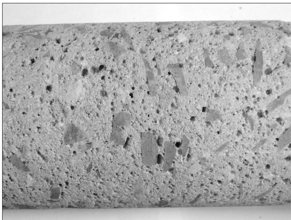
Foto 6: 2. nástupiště, základ sloupu 11; pórovitá struktura betonu základu sloupu (pro zvýraznění černobílé foto)
