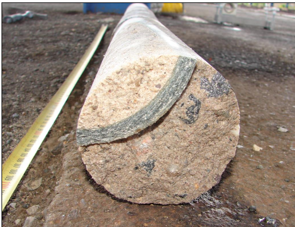
Foto 4: 2. nástupiště, základ sloupu 11, jádrový vývrt 2; azbestocementová roura vyplněná cementovou maltou
