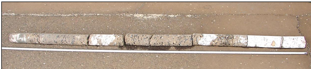
Foto 13: 2. nástupiště, základ sloupu 13 (Zpráva 1600 J 195 [11], Příloha 3, foto 50); vizuálně se beton základu jeví jako beton mírně horší kvality (zejm. ve spodní části základu; foto 14) oproti betonu základů sloupů 2 a 11 na 2. nást. diagnostikovaných v tomto doplňkovém STP
