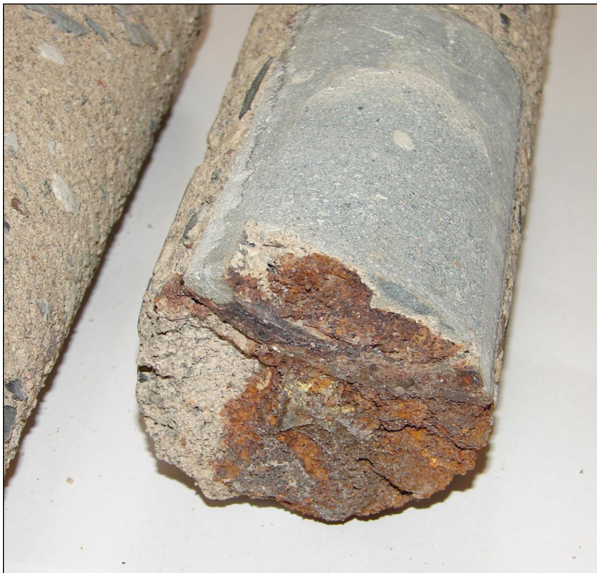
Foto 7: 3. nástupiště, základ sloupu 2, jádrový vývrt 4; azbestocementová roura vyplněná cementovou maltou, vývrt je v hl. 1,0 m pod horním lícem základu zakončen korozními zplodinami, které velmi pravděpodobně pocházejí z ocelového prvku v základu
