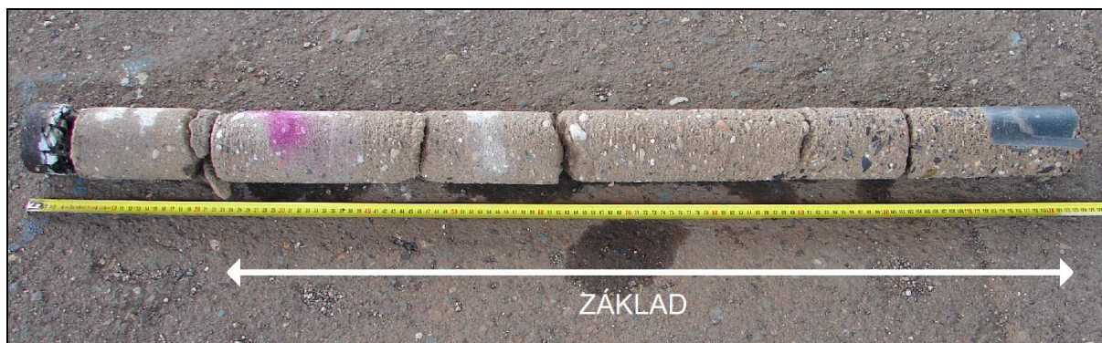
Foto 8: 3. nástupiště, základ sloupu 2; jádrový vývrt po odběru
