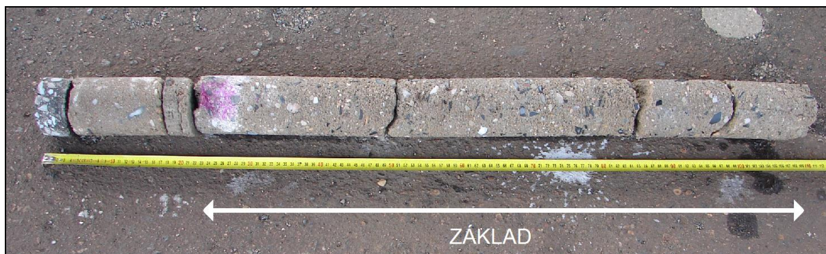
Foto 7: 3. nástupiště, základ sloupu 13; jádrový vývrt po odběru
