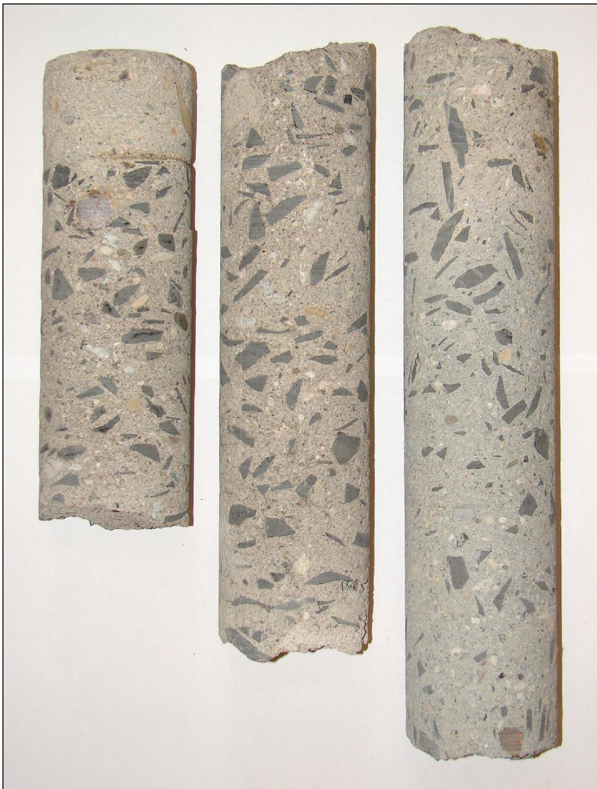
Foto 3: 2. nástupiště, základ sloupu 2; jádrový vývrt ze základu sloupu
