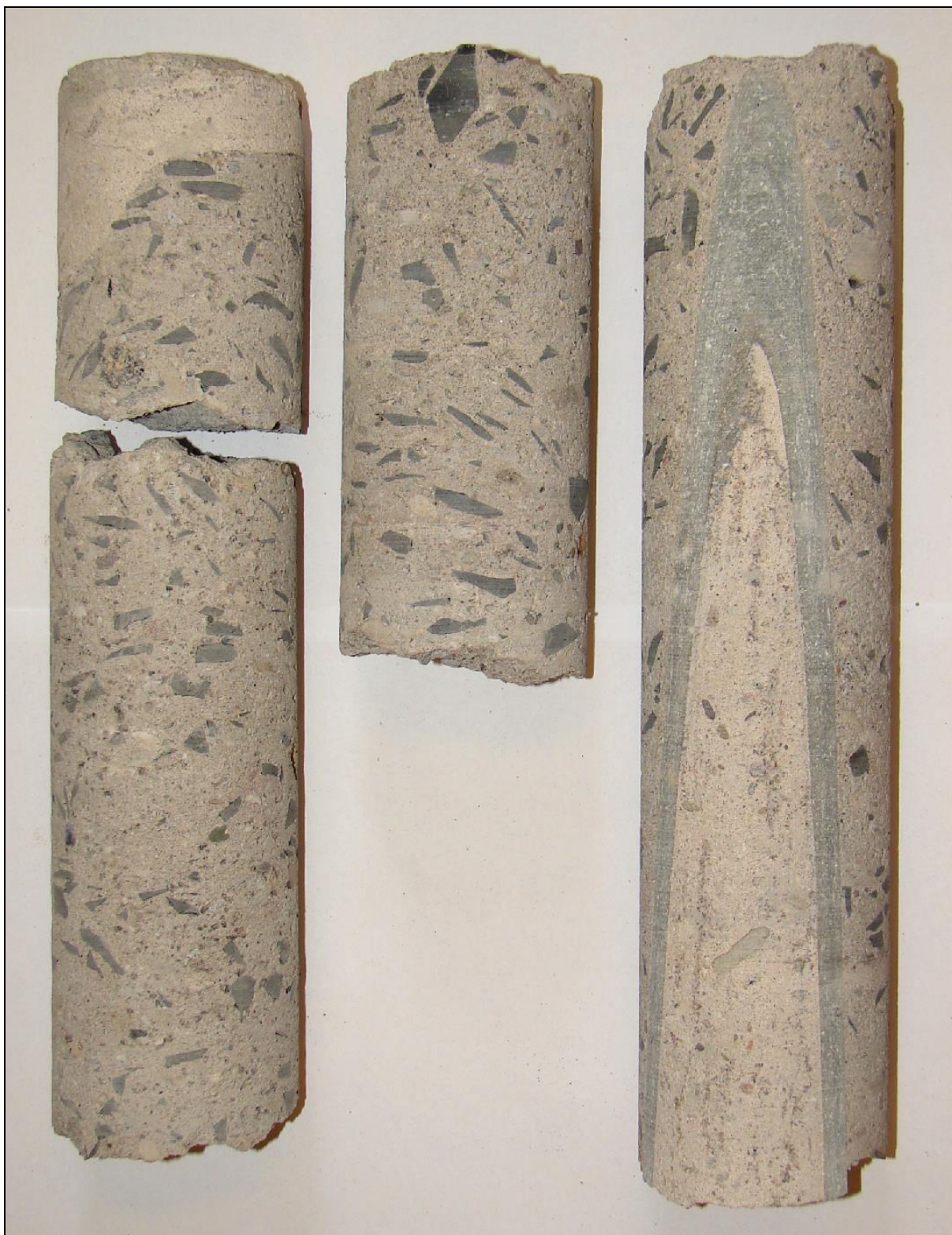
Foto 4: 2. nástupiště, základ sloupu 11; jádrový vývrt ze základu sloupu, patrna je zastižená azbestocementová roura vyplněná cementovou maltou (foto 2), vývrt byl veden mírně šikmo do středu základu proti kotevnímu šroubu
