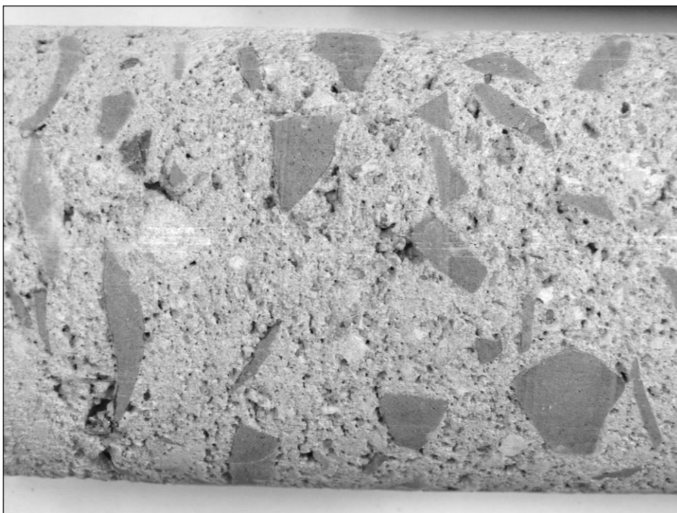
Foto 5: 2. nástupiště, základ sloupu 2; pórovitá struktura betonu základu sloupu (pro zvýraznění černobílé foto)
