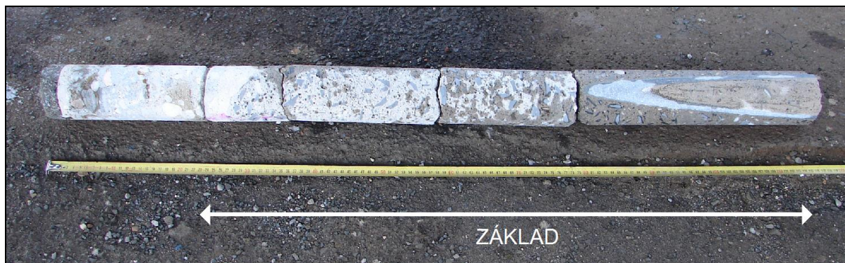
Foto 2: 2. nástupiště, základ sloupu 11; jádrový vývrt po odběru
