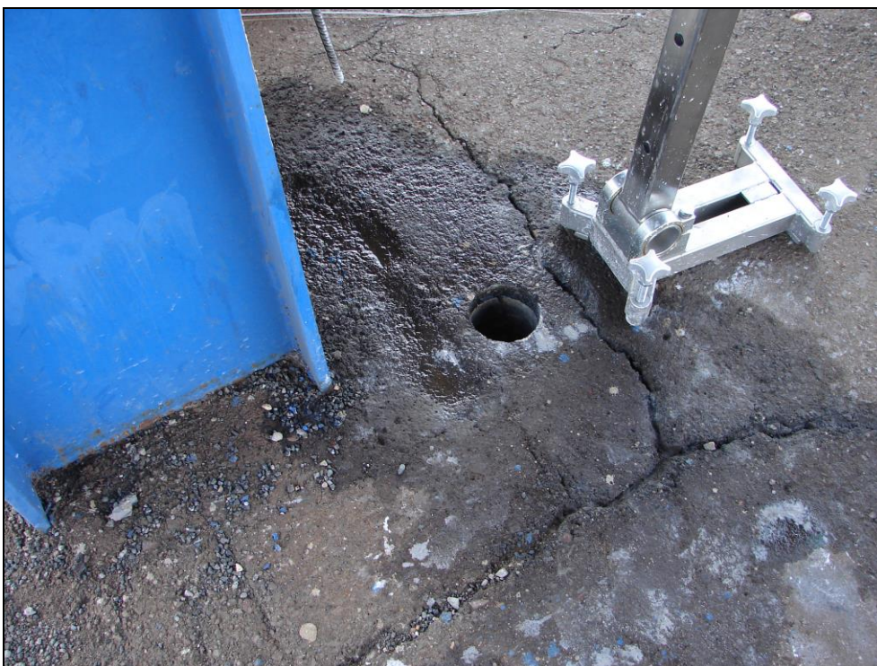
Foto 2: 2. nástupiště, základ sloupu 11, jádrový vývrt 2; pozice vývrtu proti kotevnímu šroubu, v hl. 560 mm pod horním lícem základu zachycena azbestocementová roura vyplněná cementovou maltou
