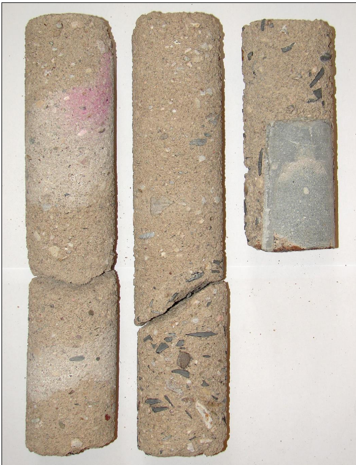
Foto 10: 3. nástupiště, základ sloupu 2; jádrový vývrt ze základu sloupu, beton vykazuje známky nízkého obsahu cementu, patrna je zastižená azbestocementová roura vyplněná cementovou maltou (foto 8)
