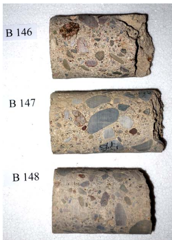
Obr. 1.: Vývrty z betonu po dodání do laboratoře
