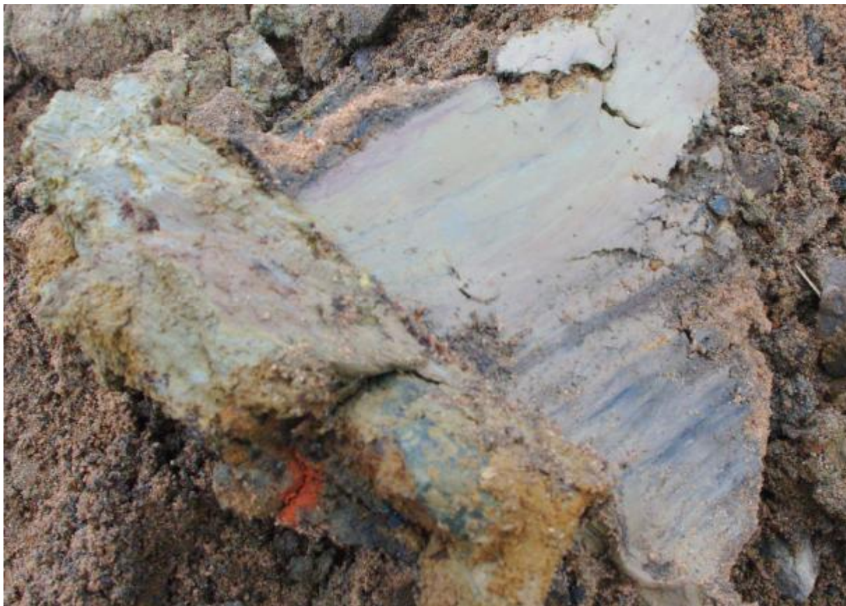
Charakter zemin zemní pláně zastoupené skupinou jemnozrnných zemin s převahou zemin tř. F3, F4, F5 a F6 (ve smyslu ČSN 73 6133)
