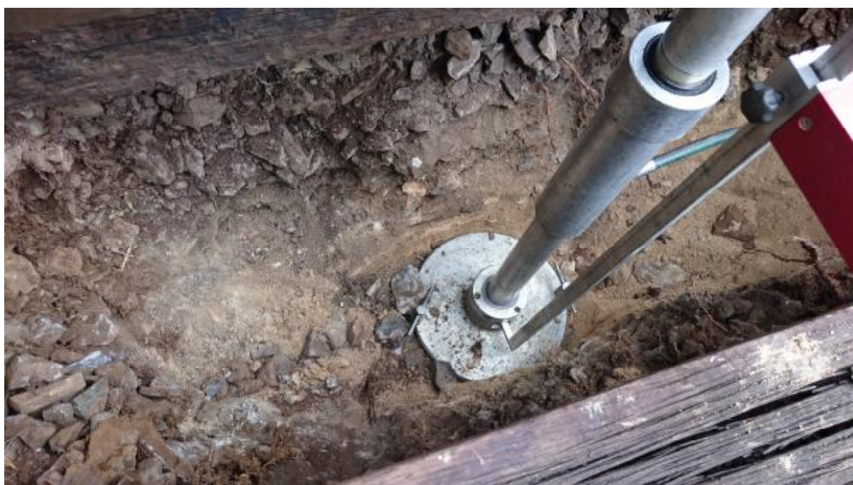
Detail provádění statické zatěžovací zkoušky v sondě K15
