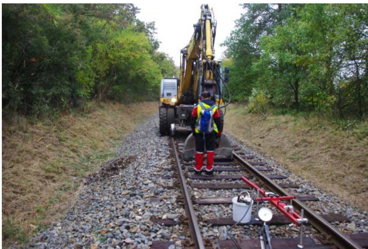
Pro realizaci kopaných sond bylo použito dvoucestného rypadla Liebherr 900, který sloužil i jako protizávaží při realizaci statických zatěžovacích zkoušek
