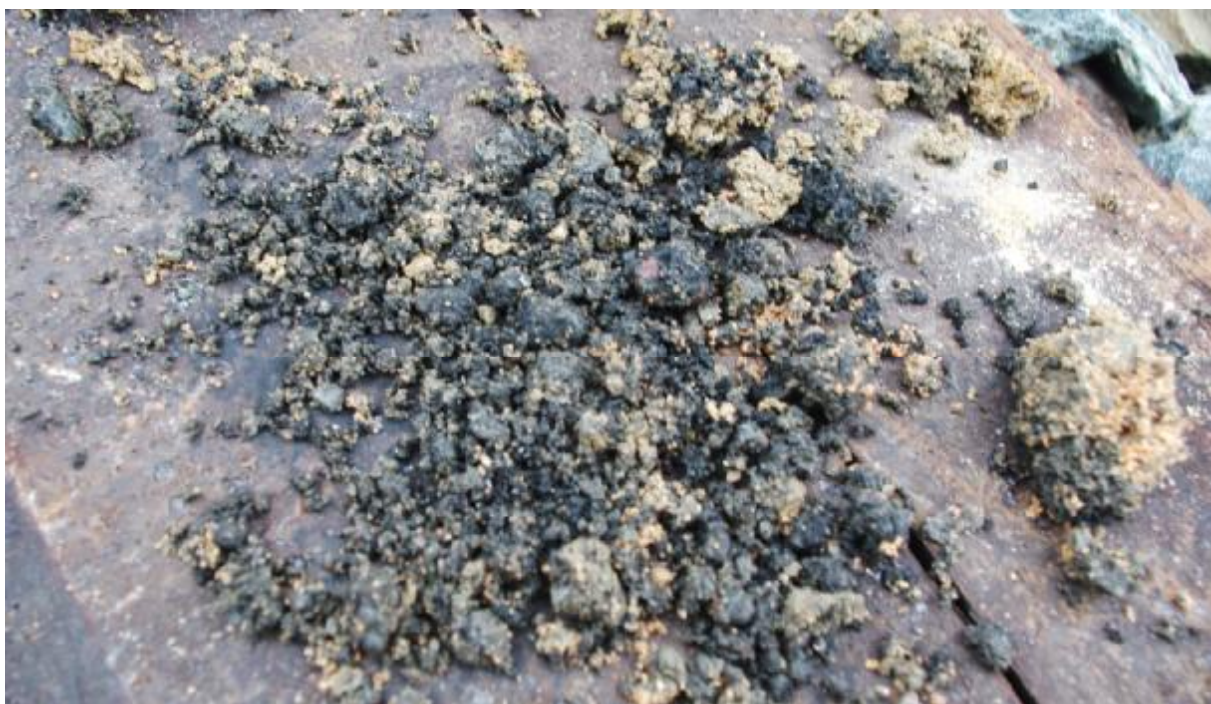
Charakter zemin v podloží štěrkového lože (směs strusky, škváry, písku, lokálně cihel – struska dominuje)
