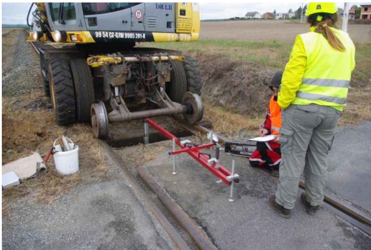
Realizace zatěžovací zkoušky v sondě K9 (u železničního přejezdu P647)
