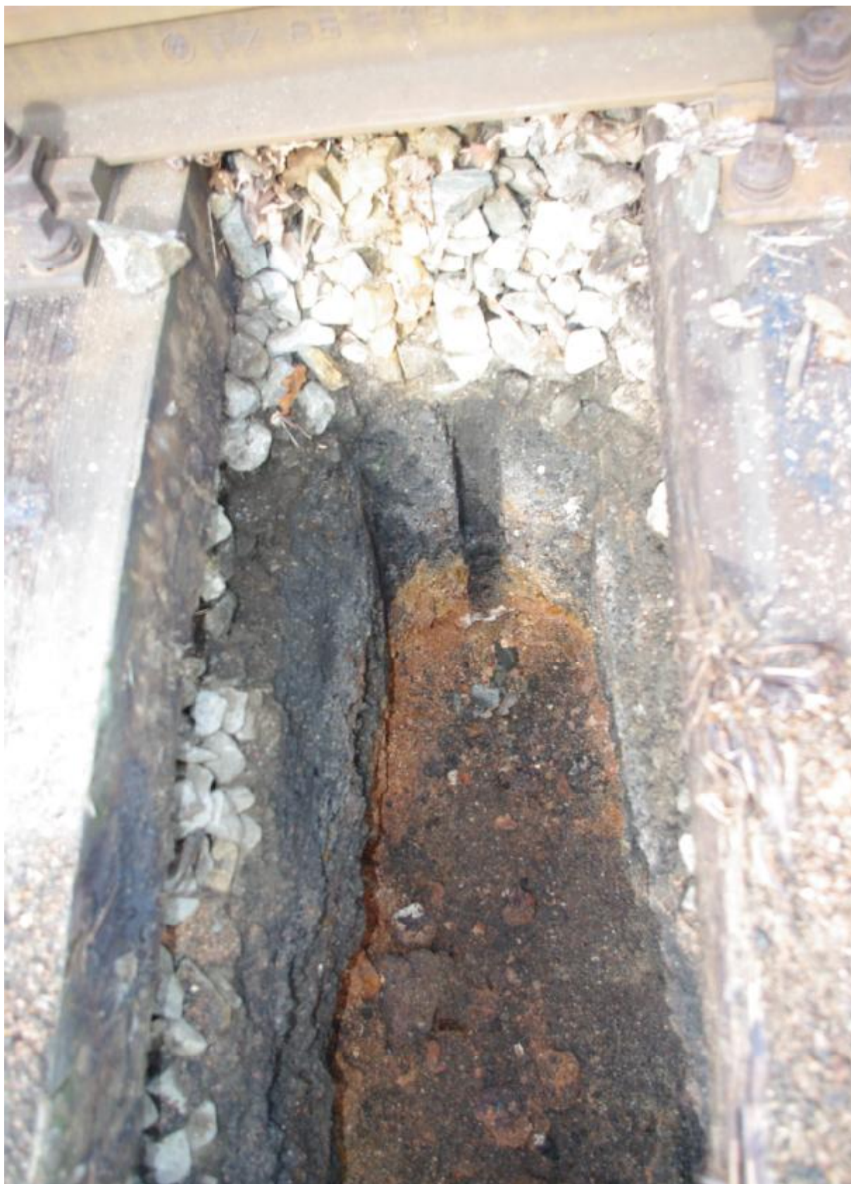
V sondě K54 (u nástupiště ve stanici Heřmanova Huť byly v podloží kolejí zastíženy dvě generace škváry) spodní červená, vrchní černá). Škvára byla ověřena do min. hl. 2,0m (provádění výkopových prací bylo poté zastaveno)
