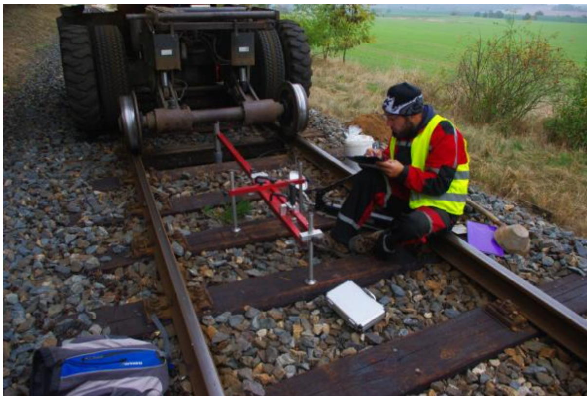
Realizace statické zatěžovací zkoušky v sondě K33
