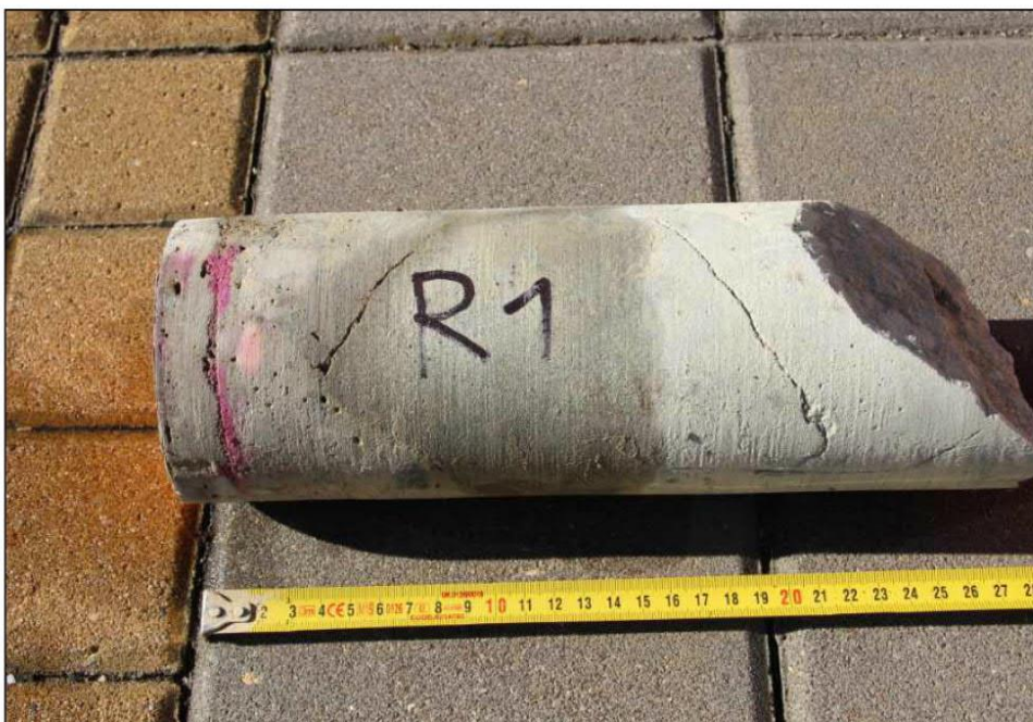
Obrázek 8 – výnos z vrtu R1 s fenolftaleinovým testem
