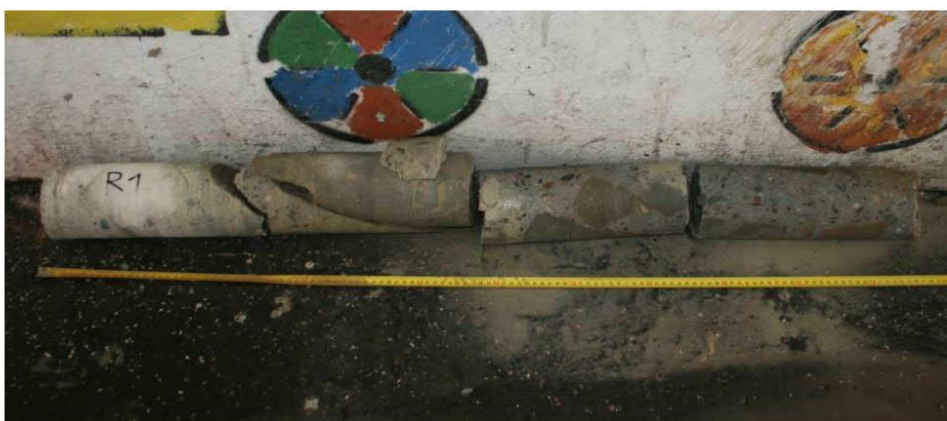
Obrázek 6 – vývrt R1, tloušťka opěry 1180 mm
