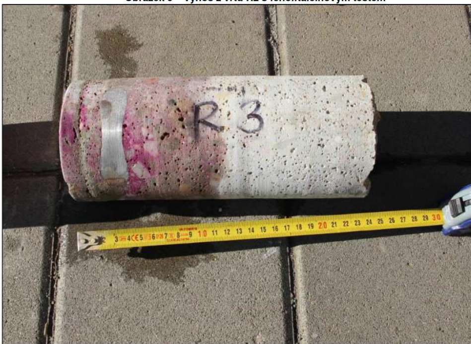
Obrázek 10 – výnos z vrtu R3 s fenolftaleinovým testem
