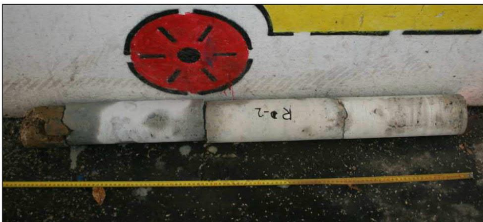
Obrázek 7 – vývrt R1, tloušťka opěry 1080 mm
