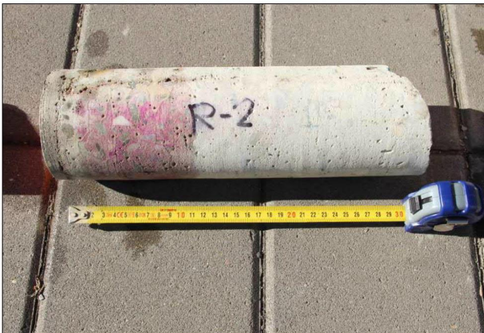
Obrázek 9 – výnos z vrtu R2 s fenolftaleinovým testem
