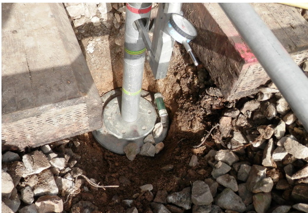
Obr.2 Statická zatěžovací zkouška v kopané sondě KS - 2
