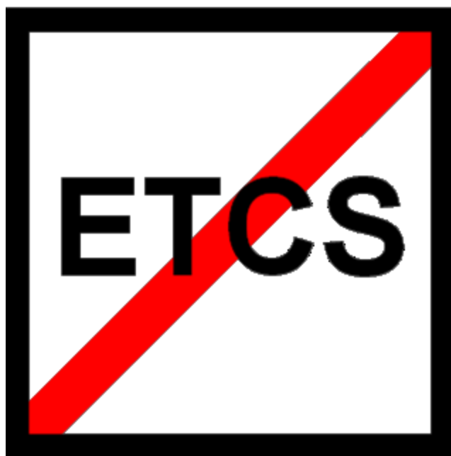
Obrázek 16: Nepřenosné návěstidlo s návěstí „Výstupní hranice oblasti ETCS“
