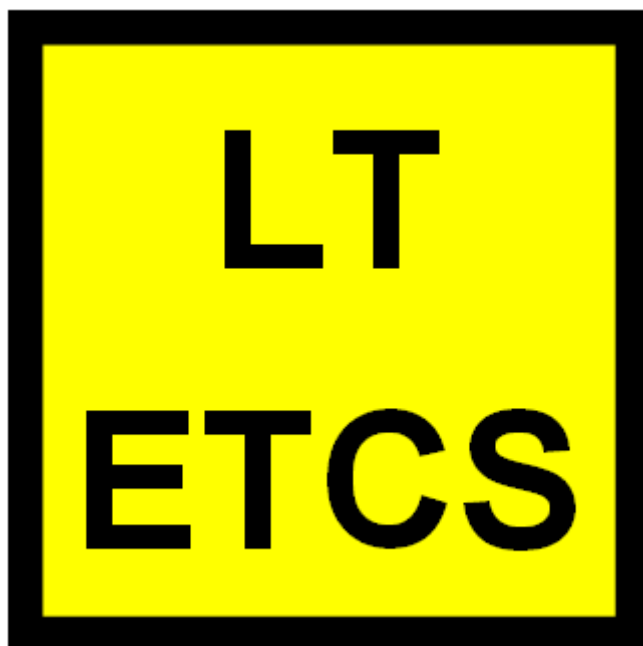
Obrázek 14: Nepřenosné návěstidlo s návěstí „Předvěst změny úrovně ETCS“
