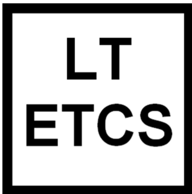
Obrázek 15: Nepřenosné návěstidlo s návěstí "Změna úrovně ETCS"
