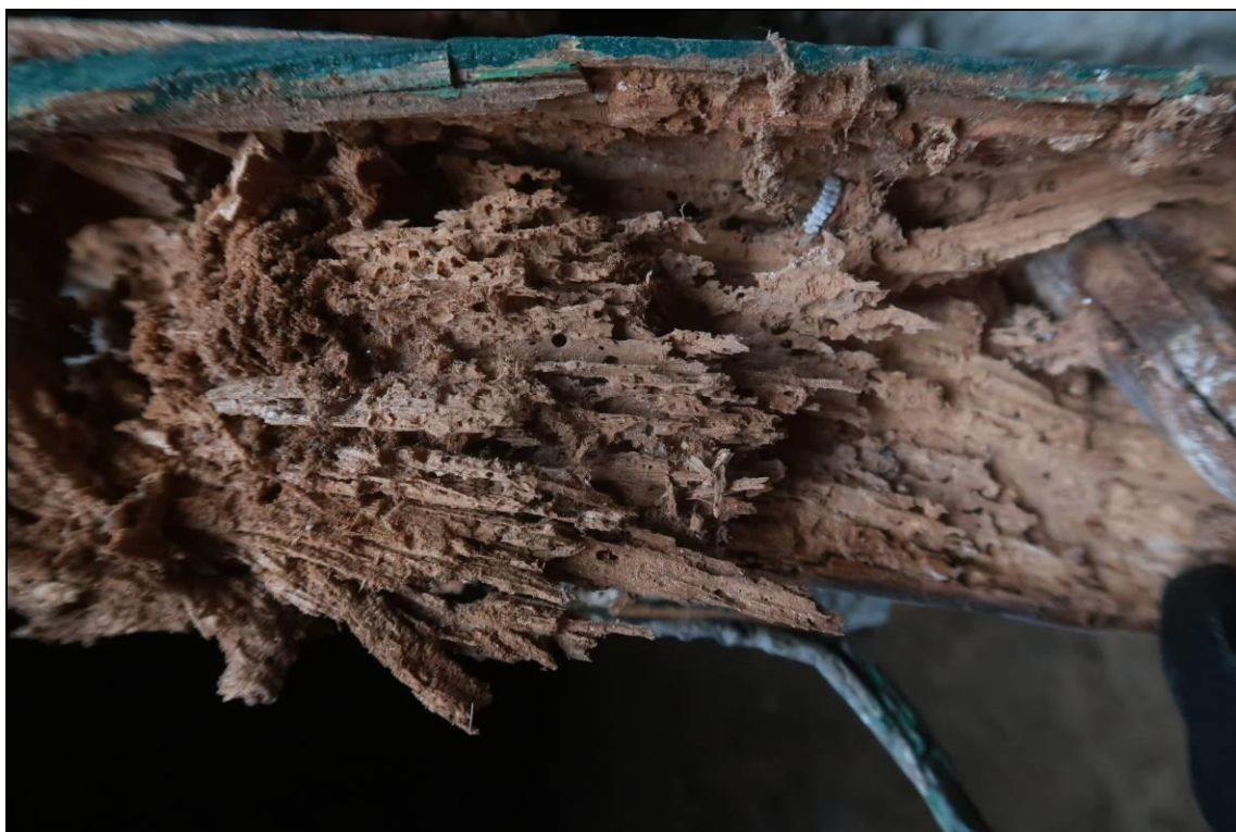
Foto 7: Dřevní hmota odebraná jako vzorek VZ3
