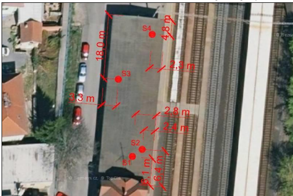
Obr. 1: Půdorys střechy včetně označení polohy provedených sond S1 až S4
