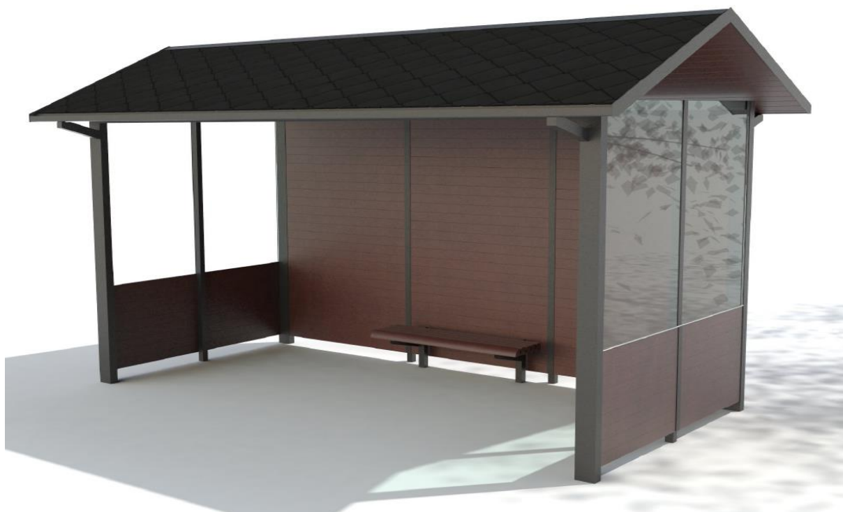
Obrázek 10: Dřevěný přístřešek – nosná konstrukce ocelová, výplně stěn dřevěné a skleněné
