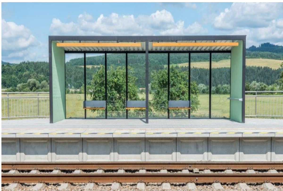
Obrázek 7: Přístřešek ocelový tvaru „U“ (Typ B.2) – jednostranné nástupiště
