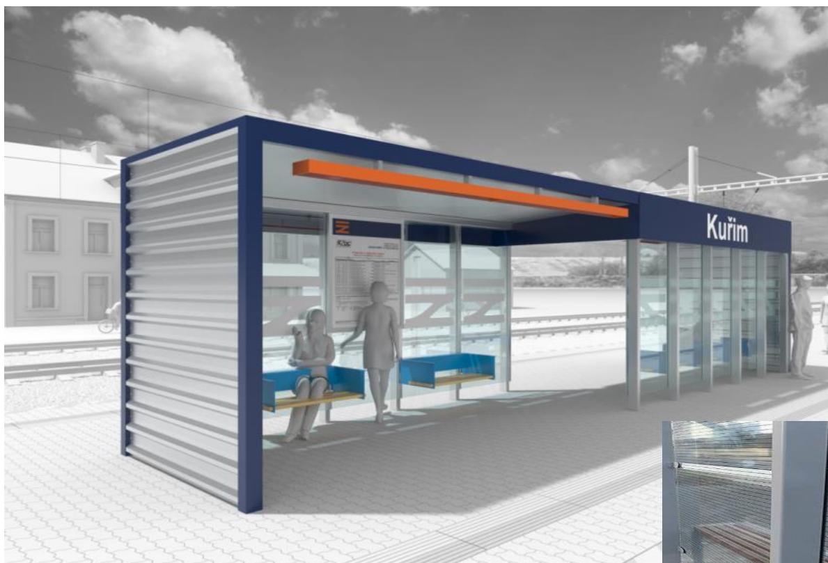
Obrázek 8: Přístřešek ocelový tvaru „U“ (Typ B.2) – ostrovní nástupiště; Detail ochrany skla proti nárazu ptáků
