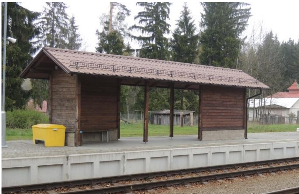
Obrázek 9: Dřevěný přístřešek – nosná konstrukce i výplně stěn dřevěné
