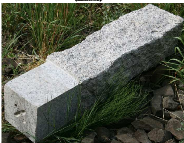
Obr.B1.3: Povrchová kamenná měřická značka M2
