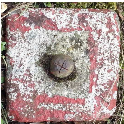
Obr.B1.4: Kámen M2 s nivelačním znakem
