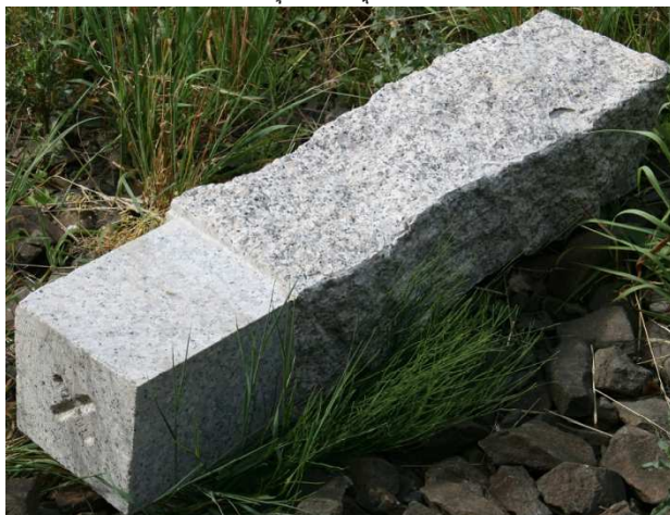
Obr.B1.3: Povrchová kamenná měřická značka M2
