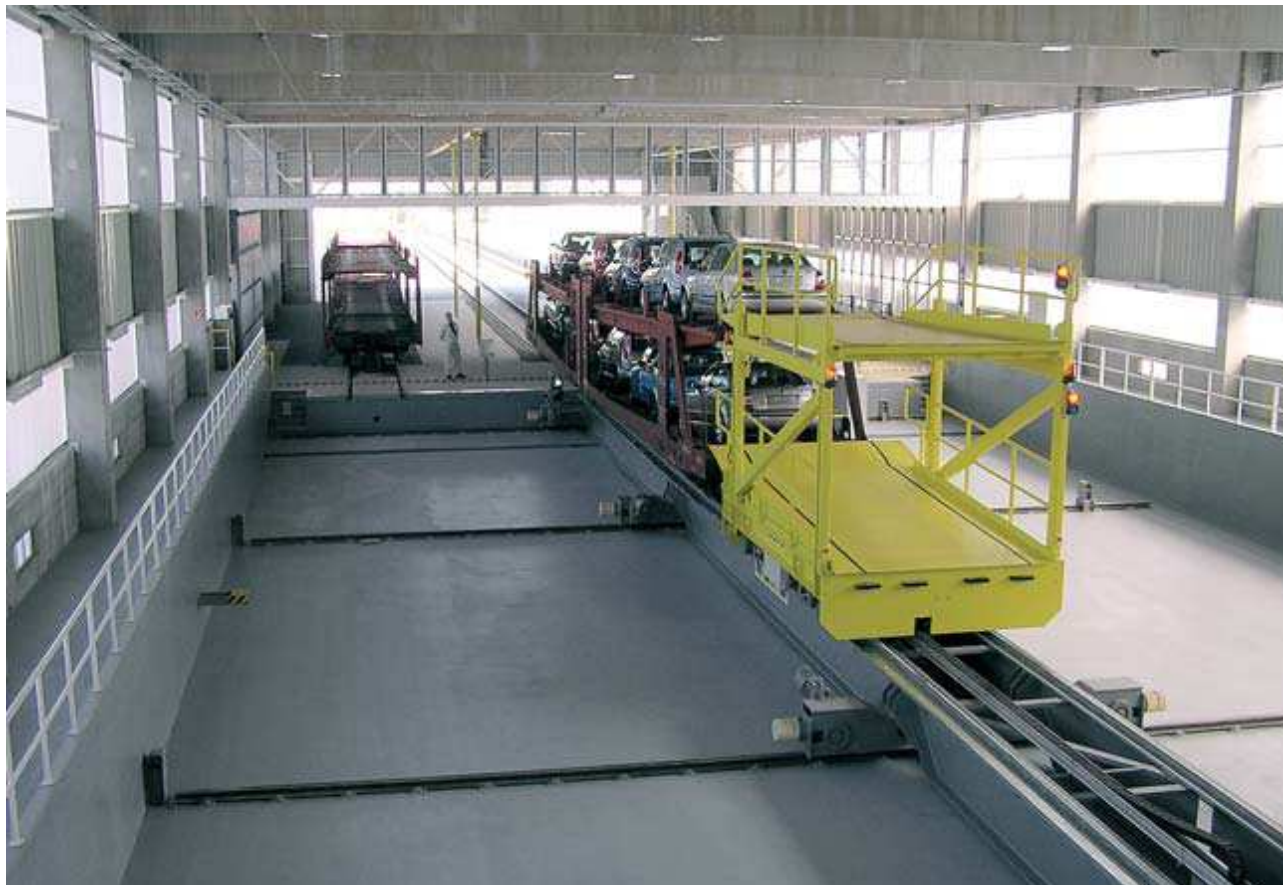
Obr.17 Nakládka osobních automobilů pomocí moderní přesuvny (Zdroj: Bulletin ČD Cargo, a.s.)
