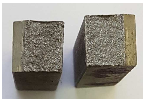
Obr. 3 Porušení zkušebních těles – křehký lom (0% smykového lomu) – Charpyho rázová zkouška, -20 °C, V-vrub
