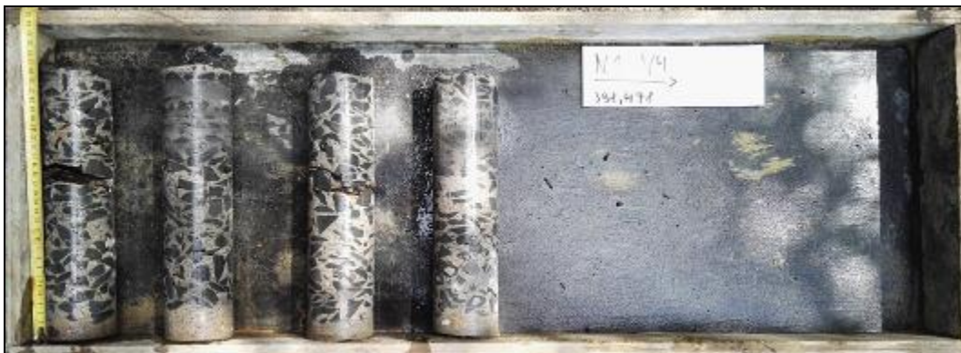
Obr. č. 5 - diagnostické návrty N1 - N4 (zleva doprava).
