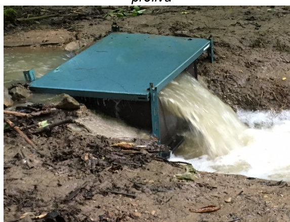
Obrázek č. 9 Vícevodný stav na měrném přelivu
