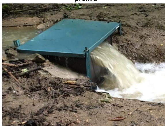
Obrázek č. 2 Vícevodný stav na měrném přelivu
