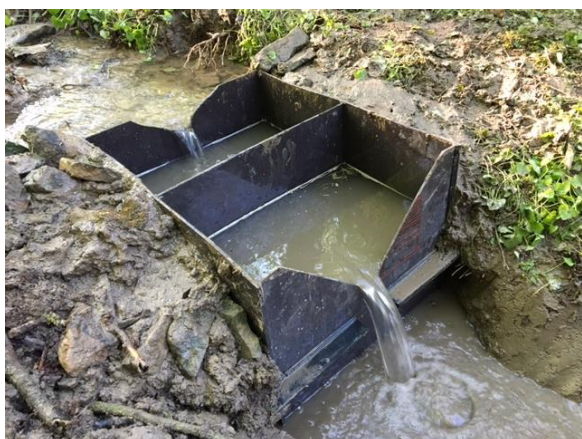
Obrázek č. 1 Instalace Thomsonova měrného přelivu
