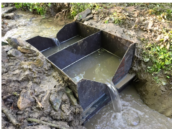
Obrázek č. 1 Instalace Thomsonova měrného přelivu
