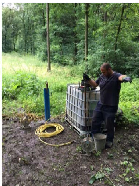
Obrázky č. 6 – 7 Nálevové zkoušky na vrtech HG-C5 a HG-C13
