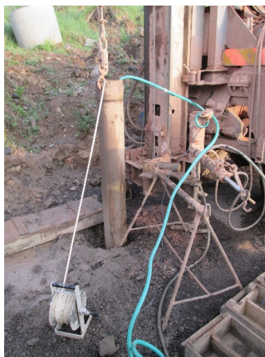
Obrázek č. 3 Průběžná čerpací zkouška na provizorně zapaženém vrtu
