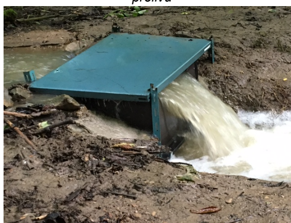
Obrázek č. 2 Vícevodný stav na měrném přelivu
