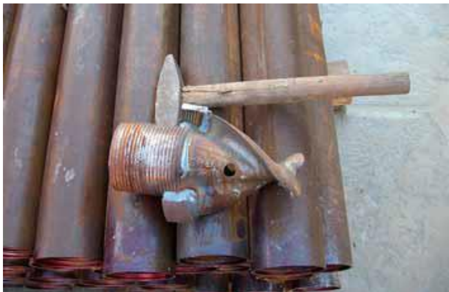
Obrázek 4: Výztuž mikropilot včetně vrtné korunky
