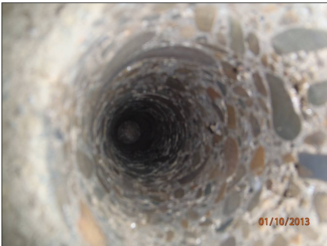
Obr. č. 4 - pohled do návrtu N2. Stěny jsou pevné, drží tvar, beton je homogenní
