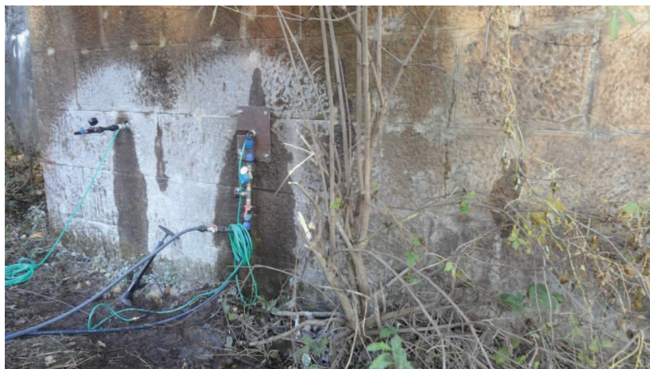
Průsaky spárami zdiva v průběhu opakované zkoušky
