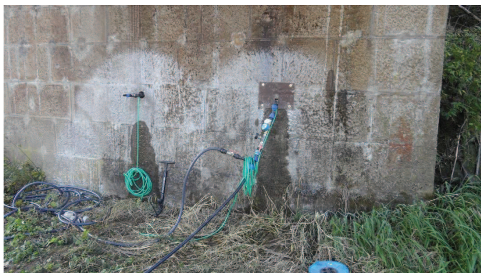
Zkušební soustava ve vrtu č. 6 včetně průsaků spárami
