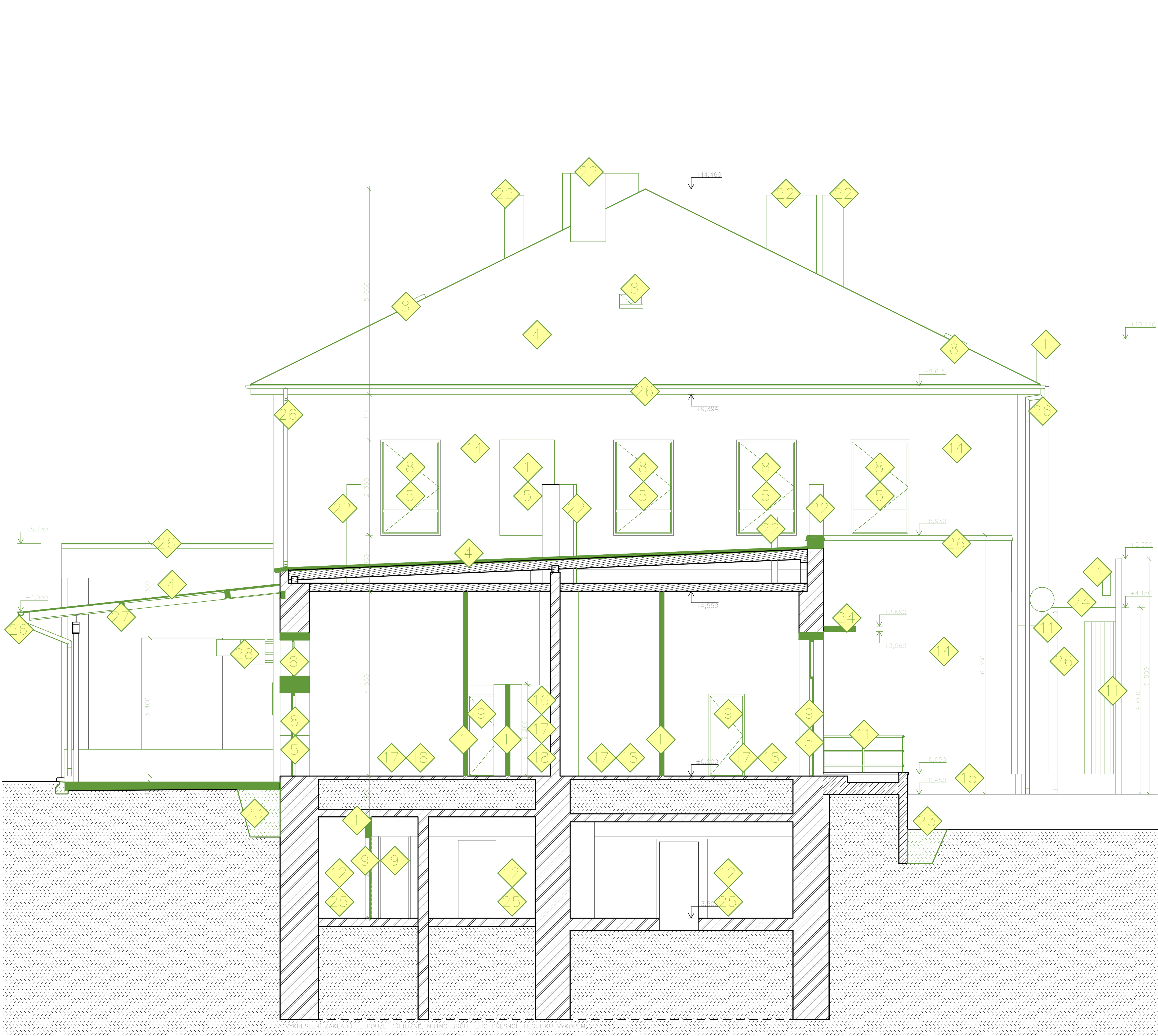
VYKRESLENÍ ZÁKLADŮ JE POUZÍ PŘÍBLIŽNÉ, NUTNO ULOŽIT JEHO PŘESNOU HLUBOKU VYKOPEM.
