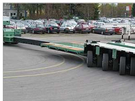
Obr.3 Příklad zatáčení návěsu říditelných podvozků
