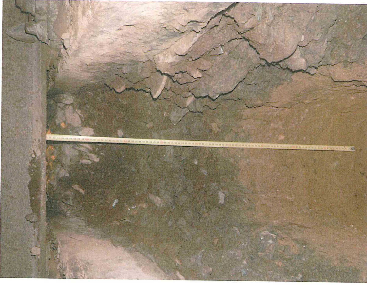
Foto č. 11 – Detail tloušťky konstrukčních vrstev sondy S2-CONSULTEST
