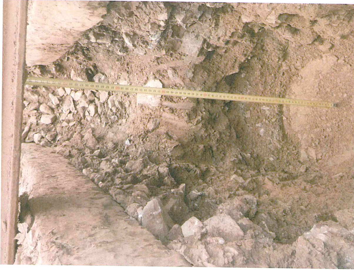
Foto č. 3 Detail tloušťky konstrukčních vrstev sondy S1
