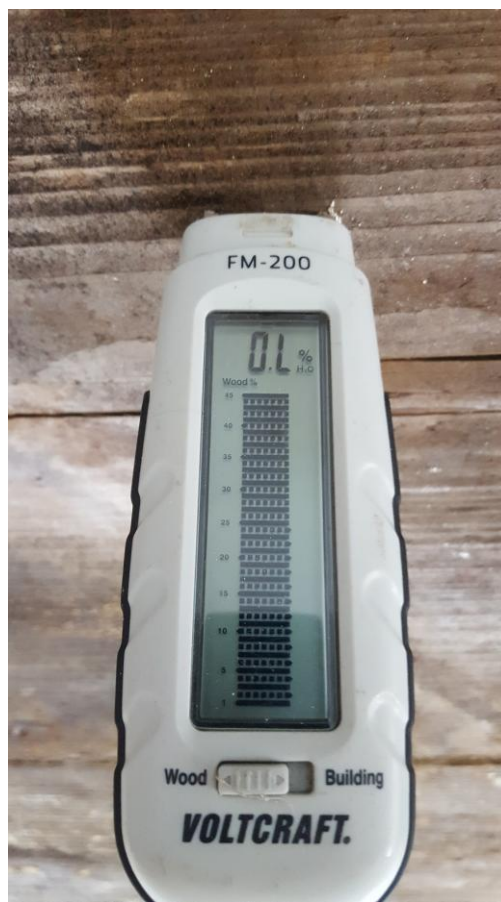
Č.15 – měření vlhkosti napadené prkenné podlahy. MAX. rozsah měřidla 60%, hodnota O.L nad 60%
