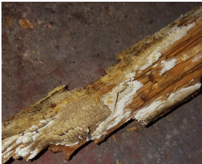
Č.27 – odebraný vzorek dřevní hmoty, odesláno k laboratornímu rozboru mykologem
