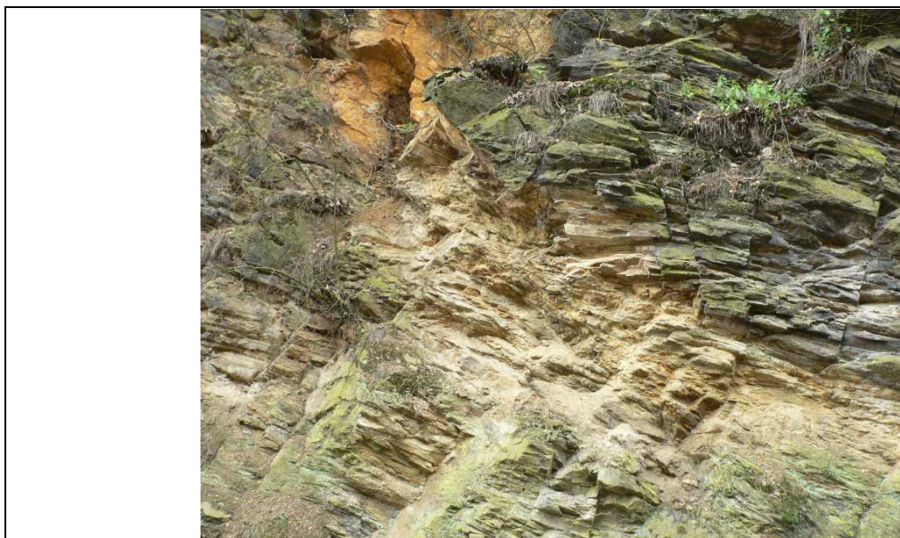
Obr. 2 - Vzhled horniny v poruchové zóně
