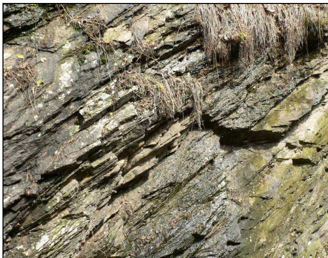
Obr. 1 - Charakteristický vzhled horniny v zářezu, s výraznými plochami foliace a orientace foliace v zářezu k ose trasy (červená linie)
