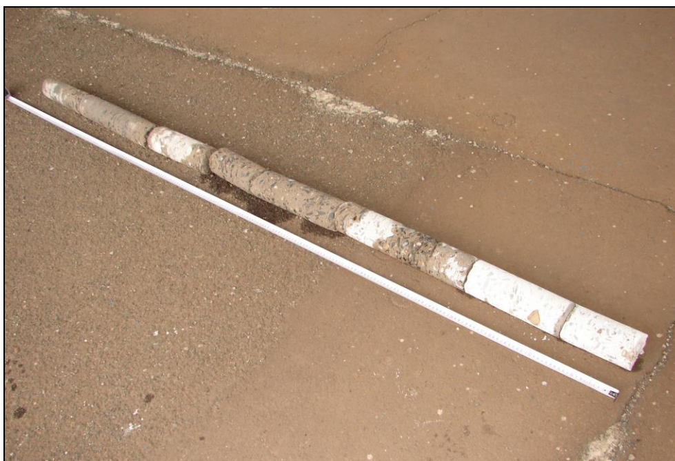
Obr. 50: Sloupy zastřešení nástupišť, 2. nástupiště, sloup 13; jádrový vývrt Ø 80 mm, délka vývrtu 2200 mm = výška patky
