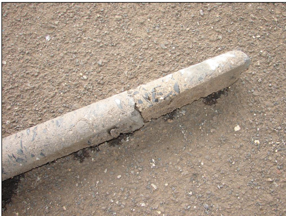
Obr. 51: Sloupy zastřešení nástupišť, 2. nástupiště, sloup 13; spodní část jádrového vývrtu, kterou byl zachycen boční líc patky
