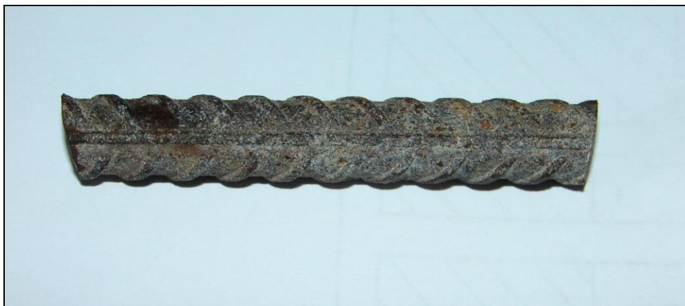
Obr. 12: Návěstidlo Lc1; výztuž Ø 12 V (10 425) zachycená jádrovým vývrtem, výztuž byla zachycena při horním i spodním líci spodního stupně patky
