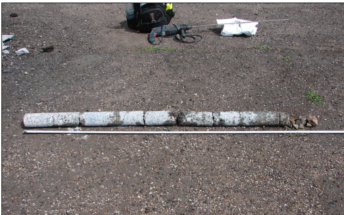
Obr. 32: Sloupy trakčního vedení, sloup 56A; jádrový vývrt Ø 80 mm, délka vývrtu 1570 mm = hloubka založení, pod patkou zastiženo drcené kamenivo (makadam)
