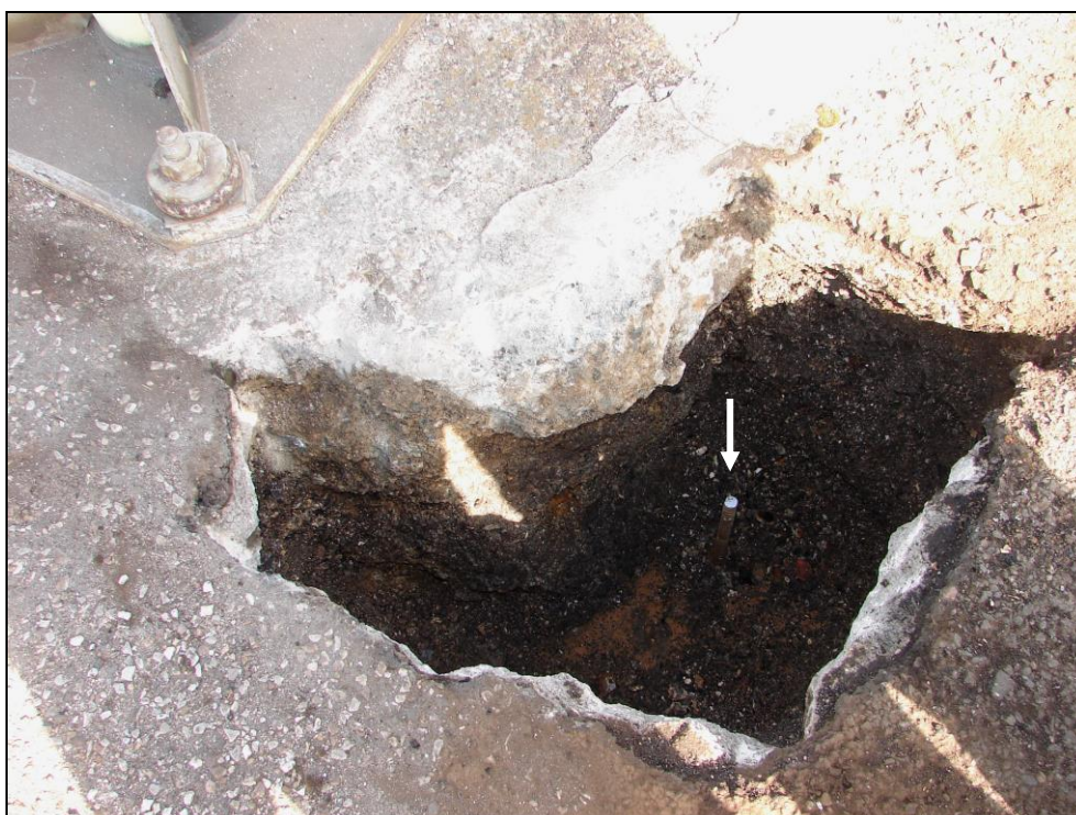
Obr. 29: Sloupy trakčního vedení, sloup 56A; pohled do sondy, šipkou je vyznačena ocelová tyč zaražená do hl. > 2,0 m pro zjištění příp. ozubu (rozšířeného stupně) patky, zásyp proveden škvárou, pod níž je písek
