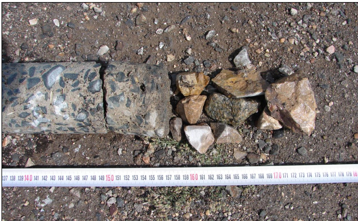
Obr. 33: Sloupy trakčního vedení, sloup 56A; drcené kamenivo zastižené pod patkou
