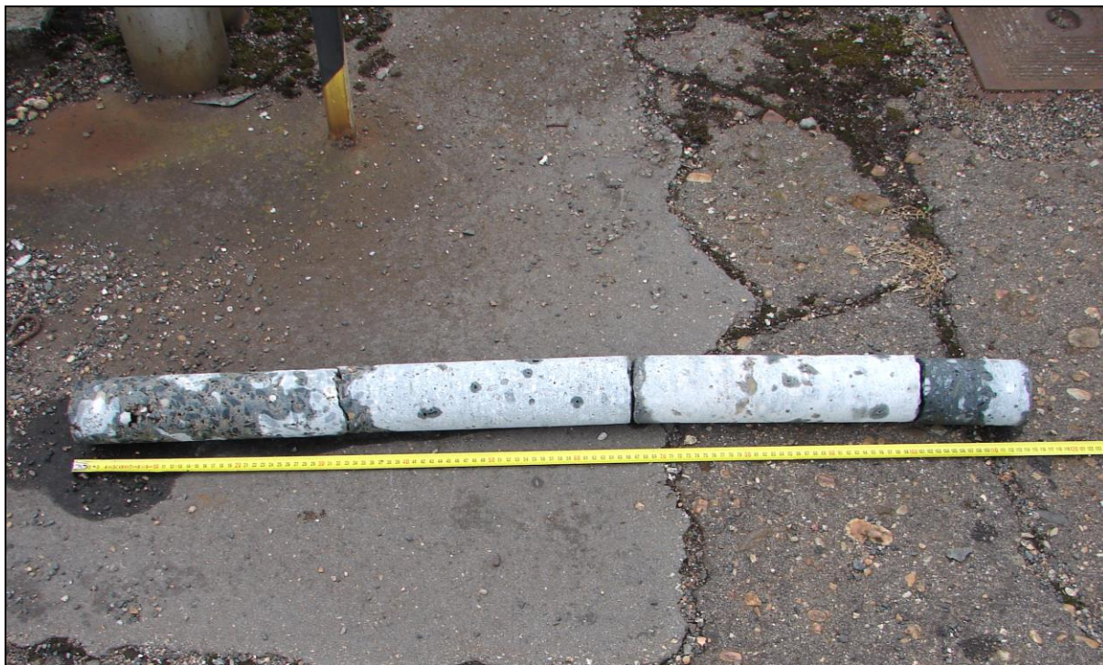
Obr. 11: Návěstidlo Lc1; jádrový vývrt Ø 80 mm ze spodního stupně patky, délka vývrtu 1130 mm = výška spodního stupně patky
