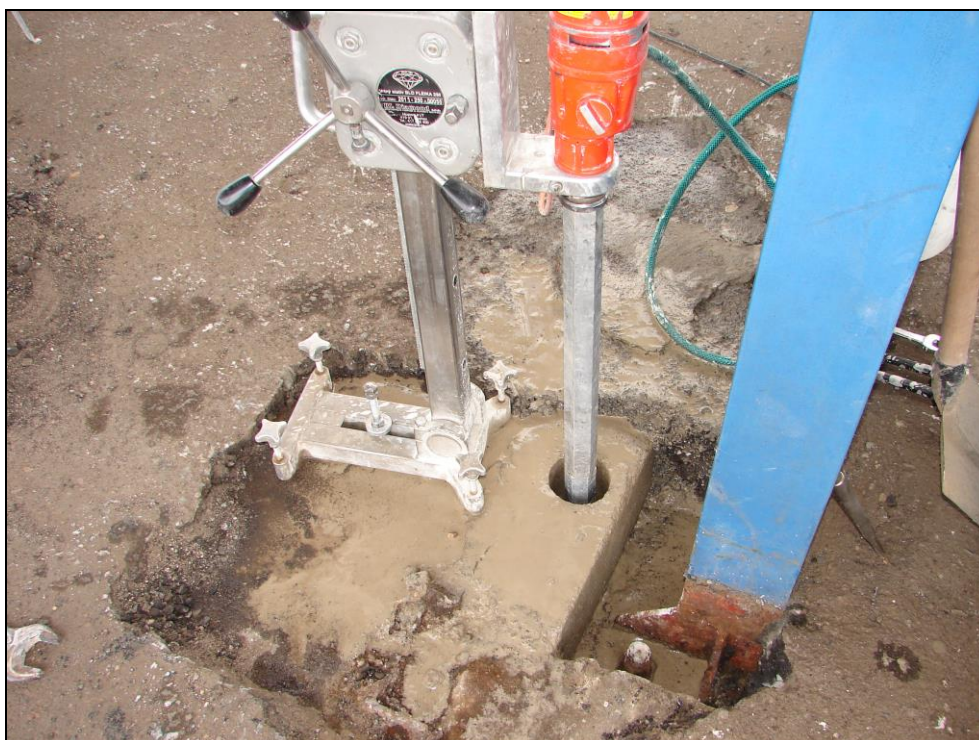
Obr. 60: Sloupy zastřešení nástupišť, 3. nástupiště, sloup 4; provádění jádrového vývrtu Ø 80 mm do patky přes betonovou obrubu pro zjištění hloubky založení
