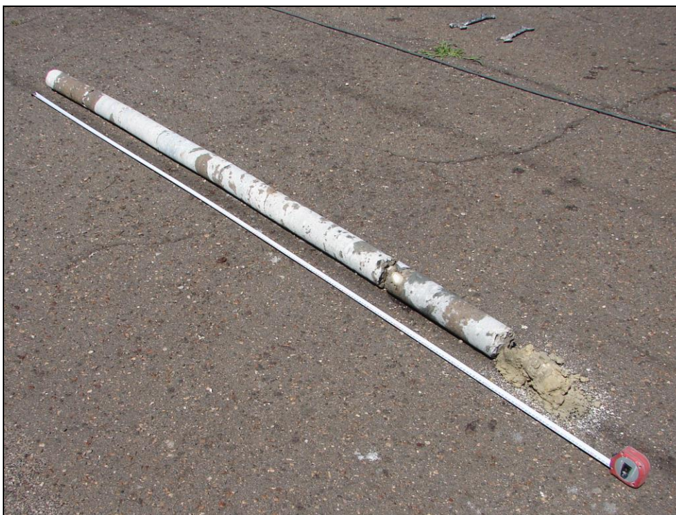
Obr. 24: Sloupy trakčního vedení, sloup 63; jádrový vývrt Ø 80 mm, délka vývrtu 2460 mm = hloubka založení, pod patkou zastižen jílem
