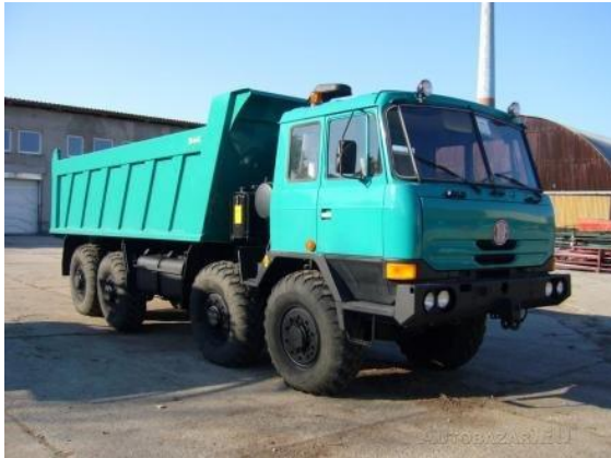
Obr. č.10 Uvažované vozidlo: Tatra 815 6x6 (s užitným zatížením 15t. Výkon motoru 300kW)
