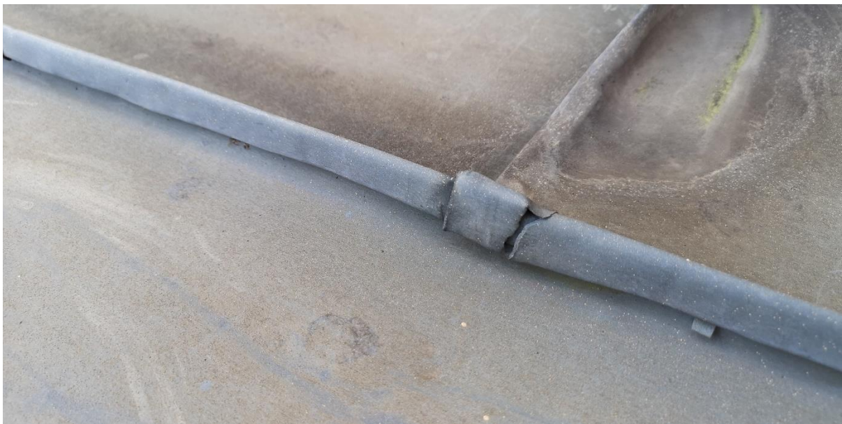
Trhliny titanzinkového plechu v mechanicky exponovaných místech
