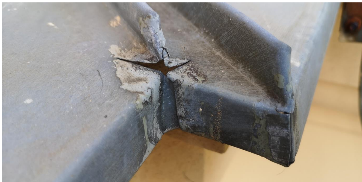
Trhliny titanzinkového plechu v mechanicky exponovaných místech
