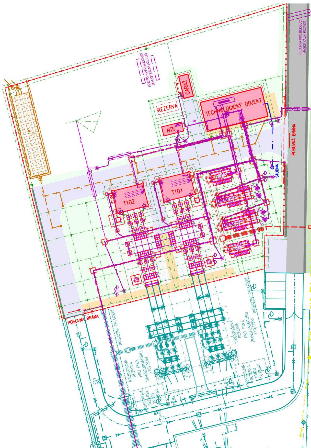
Obr. 3 Schéma umístění transformátorů v TNS Stěblová
