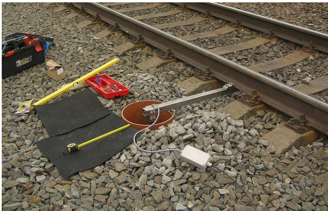
foto. č. 4 – zařízení pro snímání absolutního svislého pohybu kolejnice
