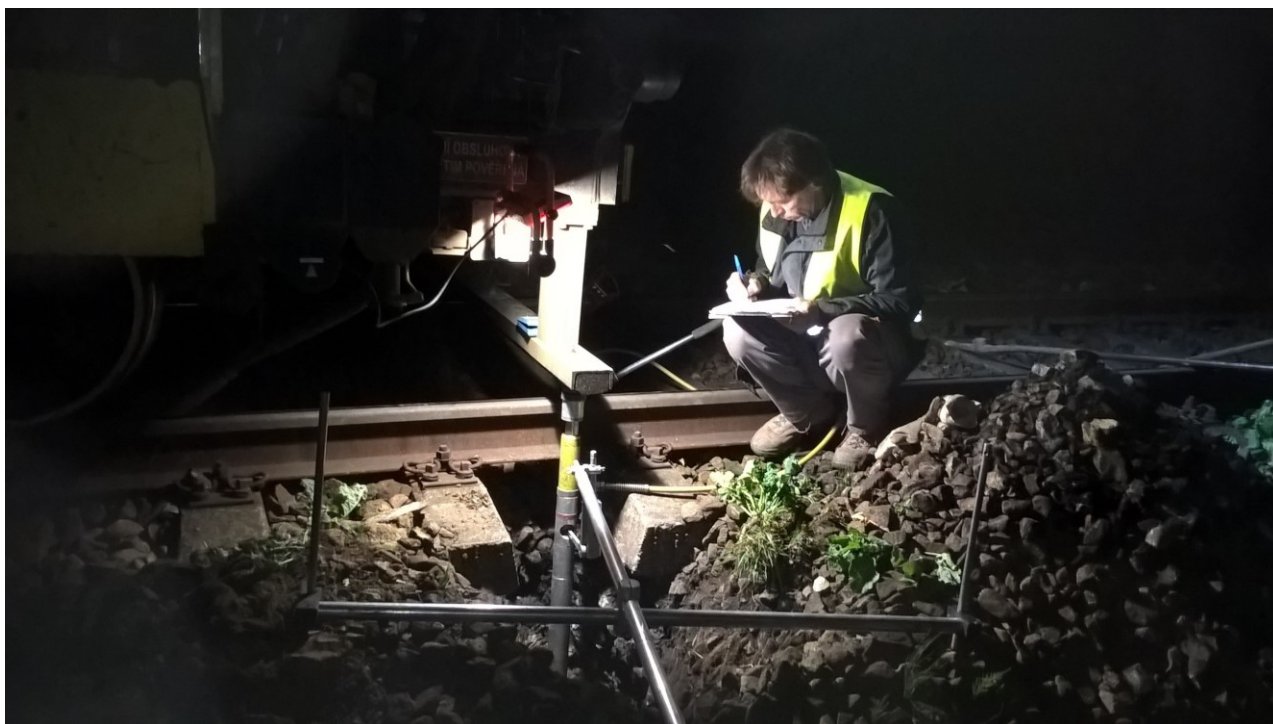
Obrázek 3: Realizace statické zatěžovací zkoušky v noční výluce
