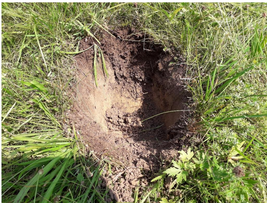
Foto č. 3: sonda provedená na parcele č. 436/19; pod 0,1 m mocnou vrstvou ornice zde byly ověřeny jíly třídy F6
