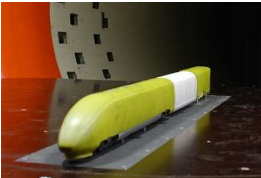
Obr. 2.2 Model ICE 3, pohled od hlavového vozu
