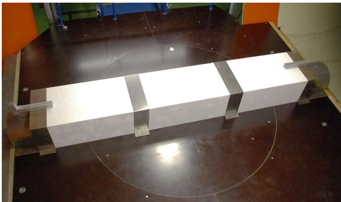
Obr. 2.6 Model tunelu v měřicím prostoru aerodynamického tunelu
