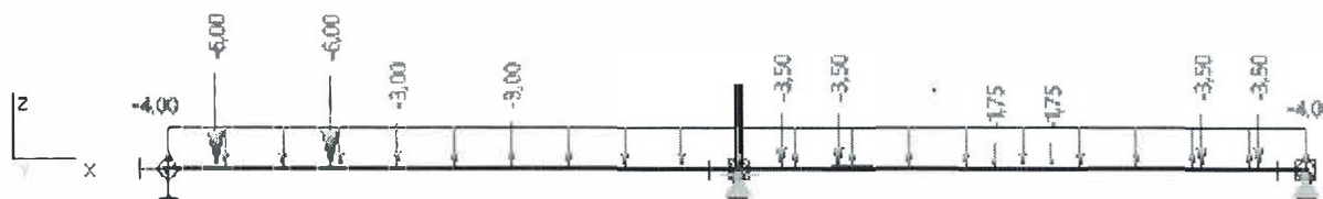
Obr. 3: Zatížení ocelového nosníku užitným zatížením
