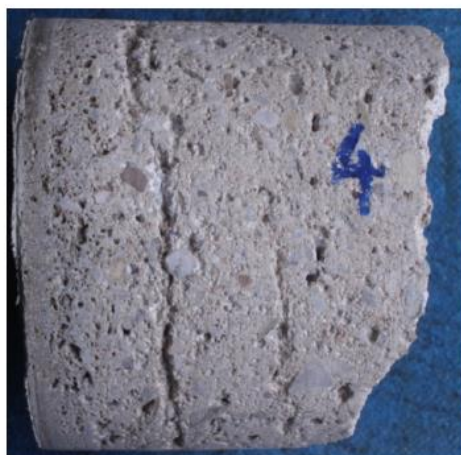
Obrázek č. 9: Fotodokumentace vývrtnu V4 – vývrt s deaminačními trhlinami
