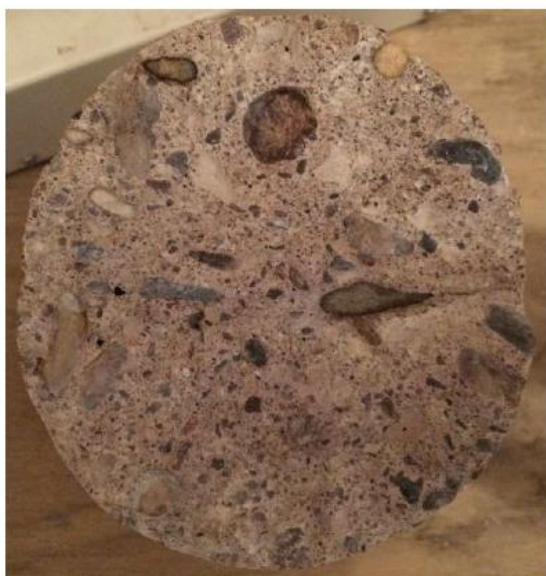
Obrázek č. 2: Fotodokumentace kolorimetrické zkoušky na vývrtu V1
