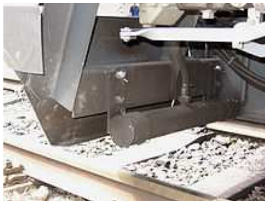
Příklad návěstního opakovače (vlevo) a snímače kódu vlakového zabezpečovače (vpravo)
