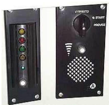
Příklad návěstního opakovače (vlevo) a snímače kódu vlakového zabezpečovače (vpravo)
