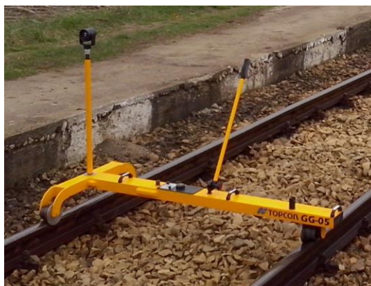
Obr. 1 Automatický merací systém TOPCON GG-05
