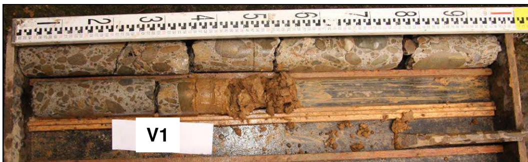
Obr. č. 1 – diagnostický vrt V1 do opěry Hustopeče n. B.
