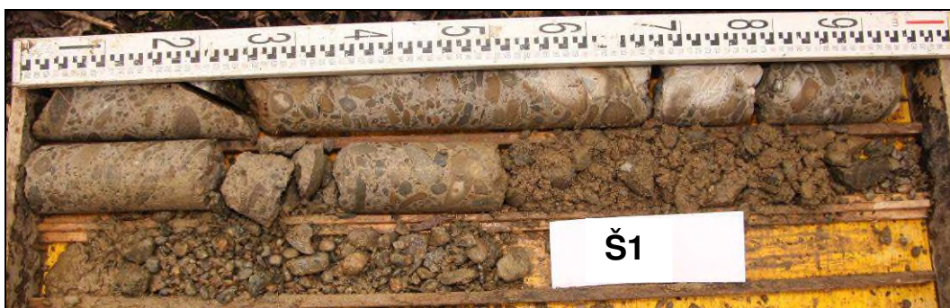
Obr. č. 2 – diagnostický vrt Š1 do opěry Hustopeče n. B.
