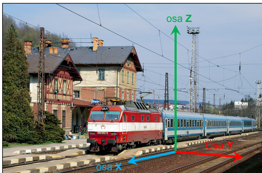
Obr. 2 Orientace os měření
