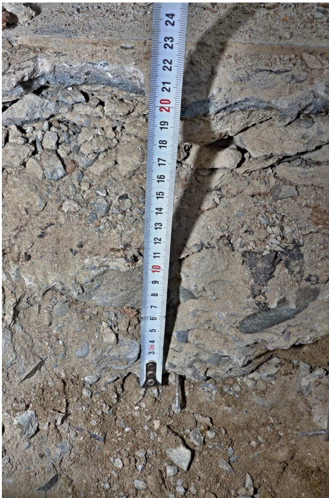
Foto č. 48 – Detailní pohled na kopanou sondu P2 do podlahy v místě mimo kanál s vytápěním
