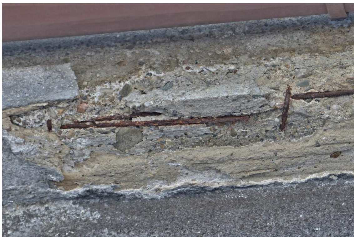
Foto č. 127 – Detailní pohled na sondu S7 ke zjištění zbytkové zkorodované výztuže
