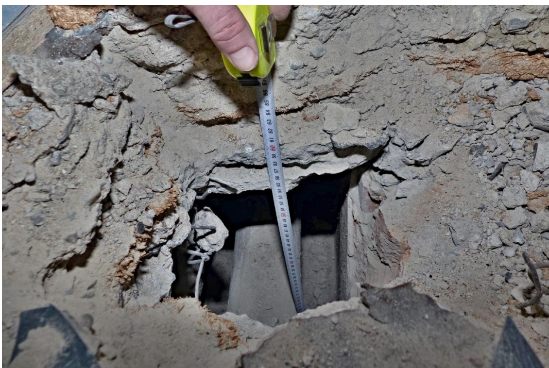
Foto č. 63 – Pohled na měření hloubky kanálu u sondy P3a nad kanálem s vytápěním
